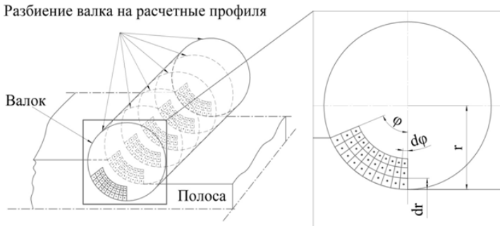
Рисунок 6. Схема численной реализации модели теплового состояния рабочего валка при взаимодействии с полосой: r – радиус рабочего валка, мм; \varphi - угол, определяющий зону контакта валка с полосой, град; d\varphi , dr – минимальный шаг при расчете теплового состояния валка по углу (град) и радиусу (мм) соответственно
