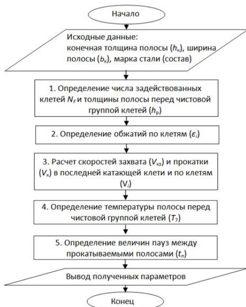
Рисунок 1 – Методика расчета технологических параметров прокатки
