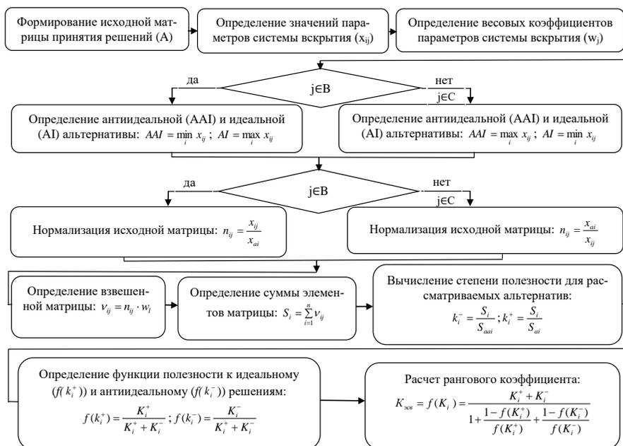
Рисунок 7 – Блок-схема расчета рангового коэффициента
