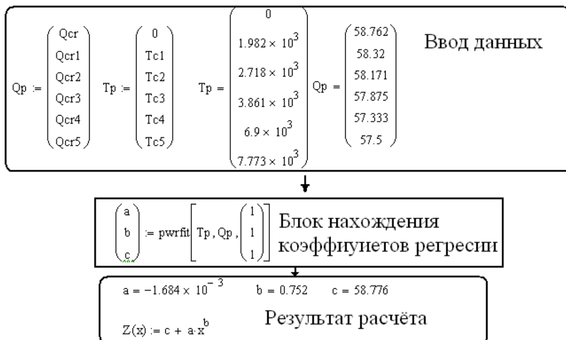
Рисунок 2.3 Схема нахождения коэффициентов регрессии
