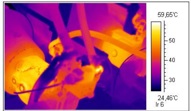
Рисунок 6.16 – Температурные поля насоса промывки, утечка по клапану управления
