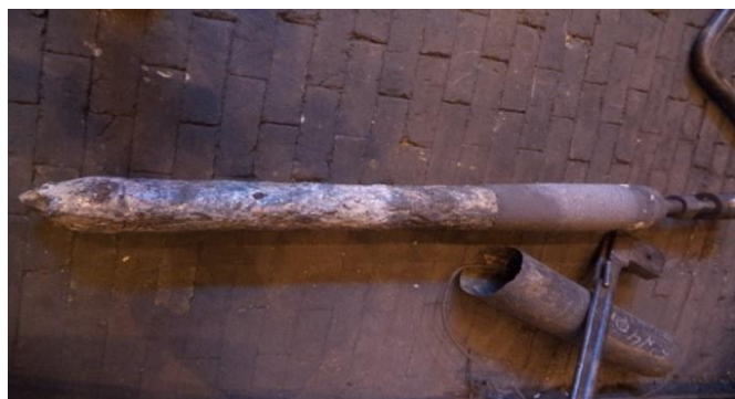
Рисунок 1.7 – Эрозия – результат воздействия агрессивных марок стали на стопор
