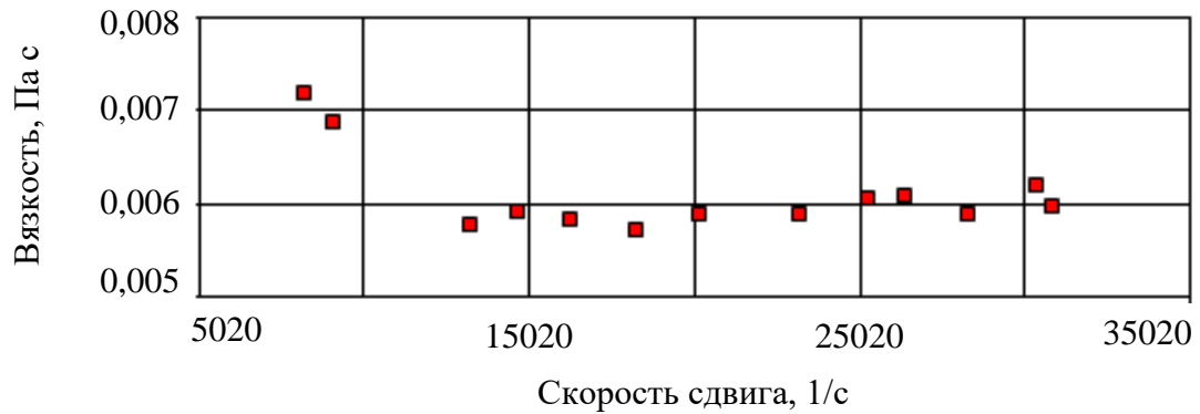
Рисунок 5.3 – Зависимость динамической вязкости керосина при постоянной температуре 23,4^{\circ}\text{C} и атмосферном давлении
