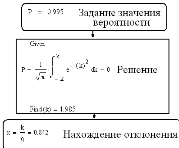
Рисунок 2.5 Элемент программного кода нахождения отклонения контролируемого параметра при принятом значении вероятности 0.995
