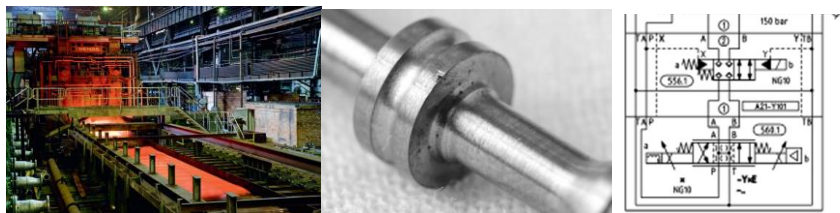
Рисунок 9 – Стан 2800 ЛПЦ№1 АО «Уральская Сталь», элемент гидросхемы управления противоизгибом и повреждённый золотник сервоклапана управления.
