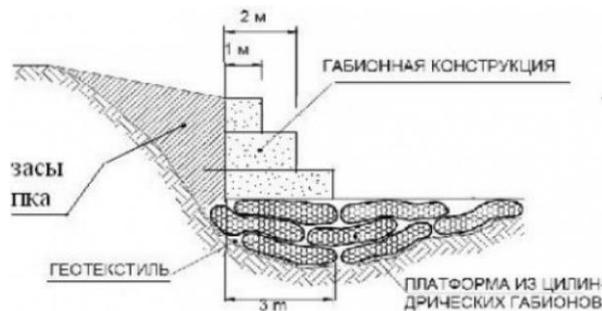
Рисунок 2.18 – Схема цилиндрической конструкции габионов
