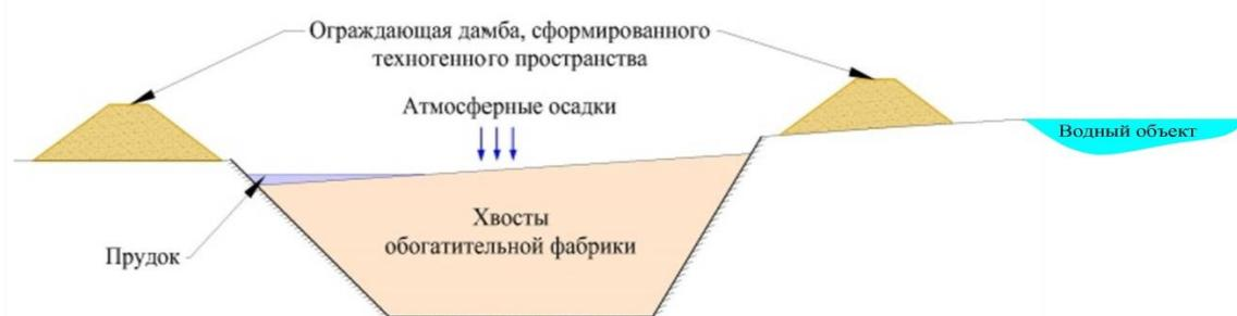
Рисунок 2.26 – Схема конвективного переноса загрязняющих веществ с расположением уровня грунтовых вод выше поверхности укладываемых хвостов
