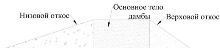
Рисунок 2.11 – Схема ограждающей дамбы
