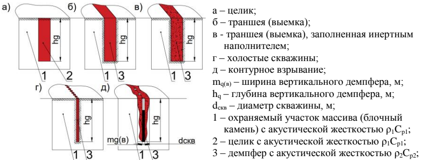
Рисунок 10 – Конструкция вертикального демпфера
