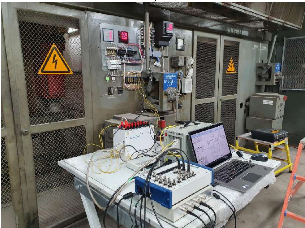
Рисунок 2.3 - Фотографии измерительных комплексов, установленных в РУ-10 кВ ГПП-2 для записи мгновенных значений напряжений и токов а – анализатор ПКЭ ELSPEC G4420 (секция 1, ф.19); б – регистраторы РЭС-3 и National Instruments (секция 2, ф.13)
