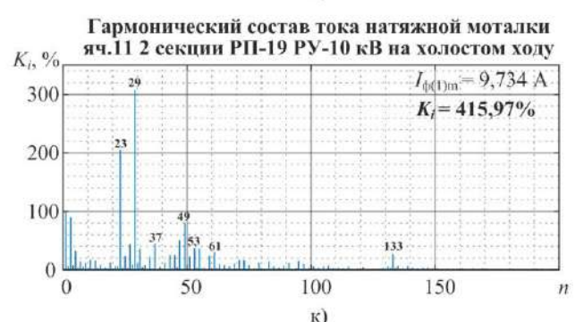
Рисунок 2.27. Анализ токов электроприводов клеток №№1-4 и моталки четырехклетьевого стана ППП ХП при работе ПЧ-АВ на холостом ходу
