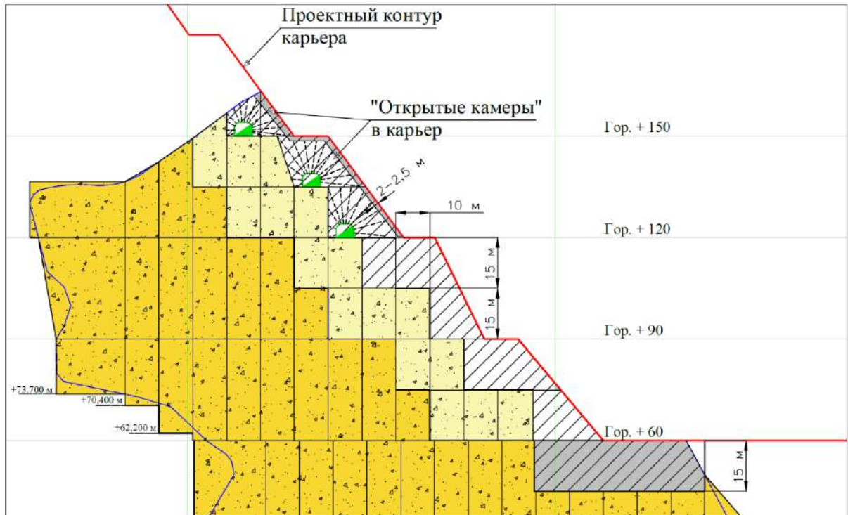
Рисунок 3.27 – Второй этап отработки барьерного целика (отработка «открытыми камерами» в карьере)
