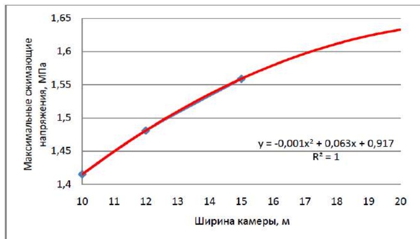
Рисунок 5.18 – Зависимость максимальных сжимающих напряжений при различных значениях ширины камеры
