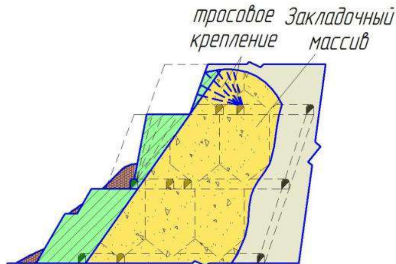
Рисунок 3.20 – Технологическая схема отработки барьерного целика открытыми заходками
