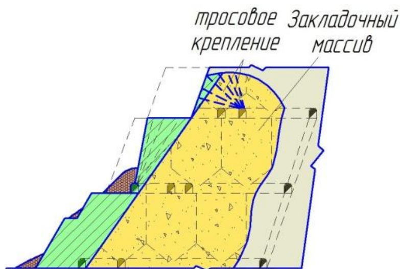
Рисунок 3.20 – Технологическая схема отработки барьерного целика открытыми заходками
