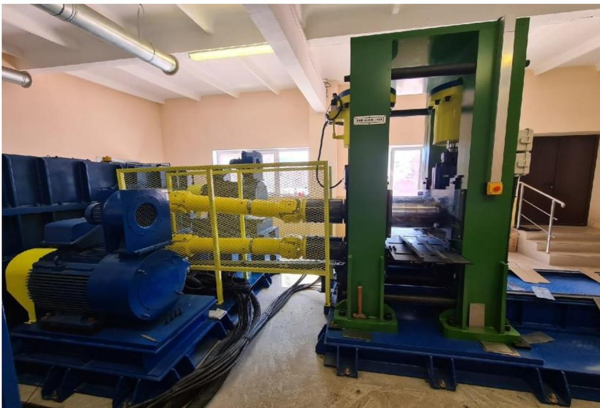
Рисунок 3.1 – Стан асимметричной прокатки 400 лаборатории механики
