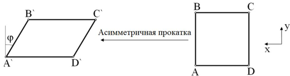
Рисунок 1.8 – Элементарная ячейка до и после асимметричной прокатки
