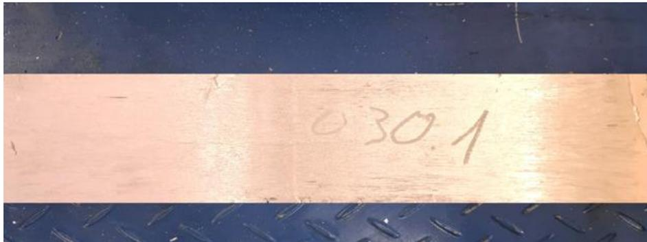
Рисунок 3.7 – Листовой слоистый алюминиевый композит 5083/1070 после второго цикла асимметричной аккумуляющей прокатки
