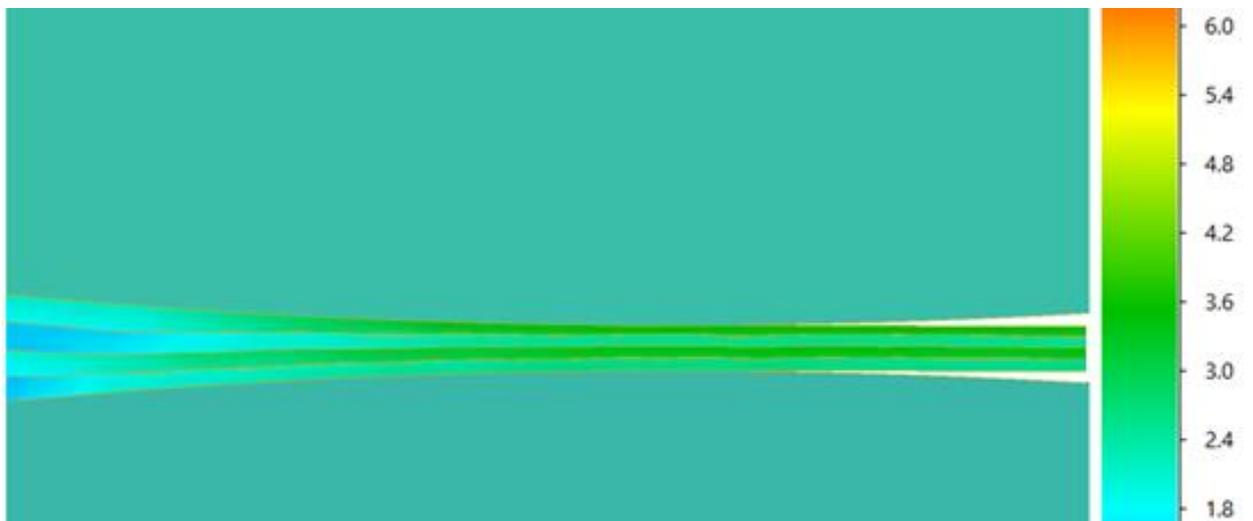
Рисунок 2.7 – Распределение деформаций во втором цикле асимметричной accumulating прокатки листового слоистого алюминиевого композита 6061/2024
