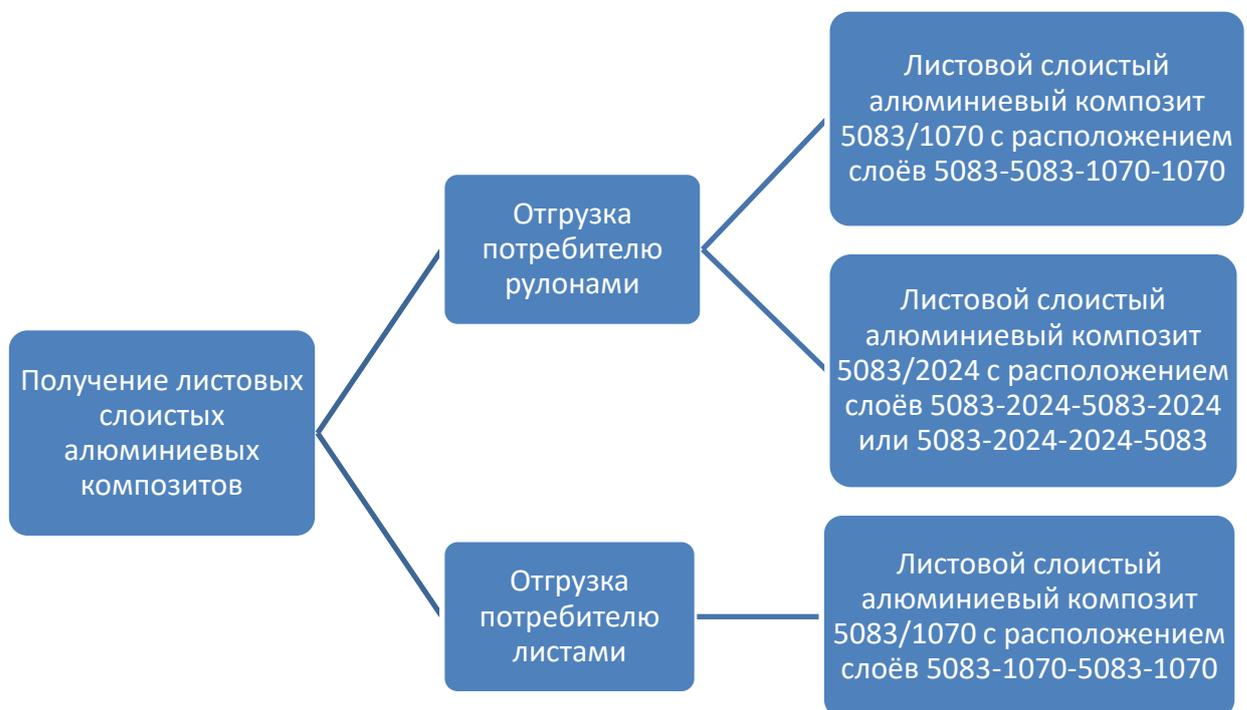
Рисунок 4.1 – Общая схема производства листовых слоистых алюминиевых композитов 5083/1070 и 5083/2024
