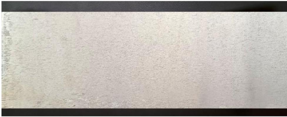
Рисунок 3.9 – Листовой слоистый алюминиевый композит 6061/1070 после второго цикла асимметричной аккумуляющей прокатки
