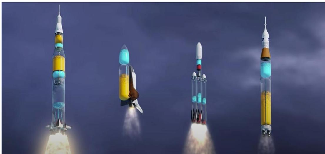
Рисунок 1.4 – Конструкции топливных баков различных ракет носителей (Saturn V, Space Shuttle, Falcon Heavy, Space launch system) [65]
