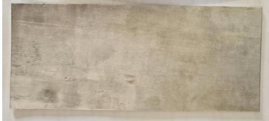
Рисунок 3.6 – Листовой слоистый алюминиевый композит 5083/2024 после второго цикла асимметричной аккумуляющей прокатки
