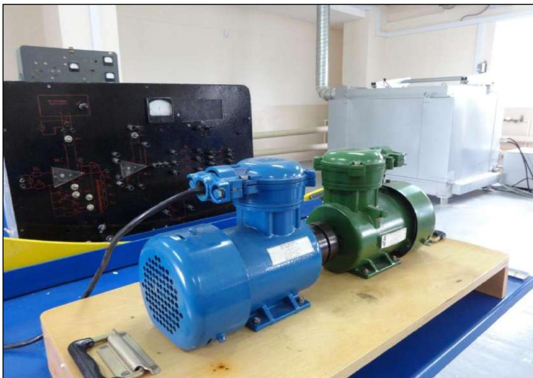
Взрывозащищенные асинхронные двигатели тип АИМЛ-71
