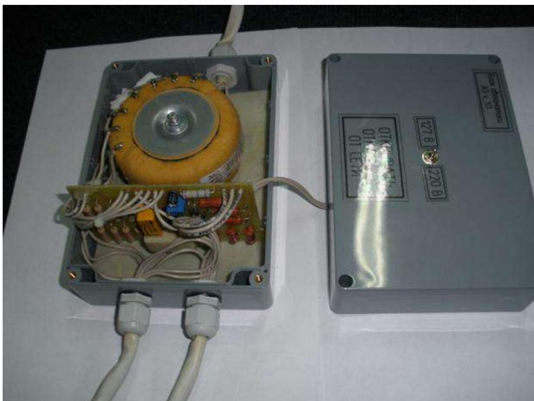
Электронный блок контроля изоляции горно-металлургического
