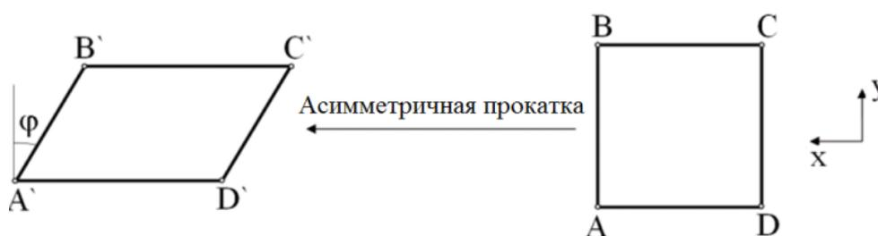
Рисунок 1.5 – Элементарная ячейка до и после асимметричной прокатки [111]
