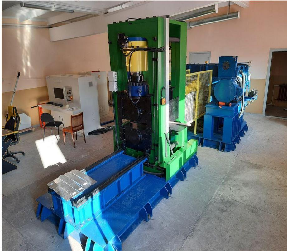
Рисунок 4.1 – Общий вид конструкции стана дуо 400 с индивидуальным приводом рабочих валков
