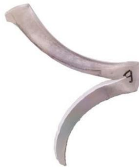
Рисунок 4.2 – Разрушенный образец Д16 после симметричной прокатки с относительным обжатием 48 %
