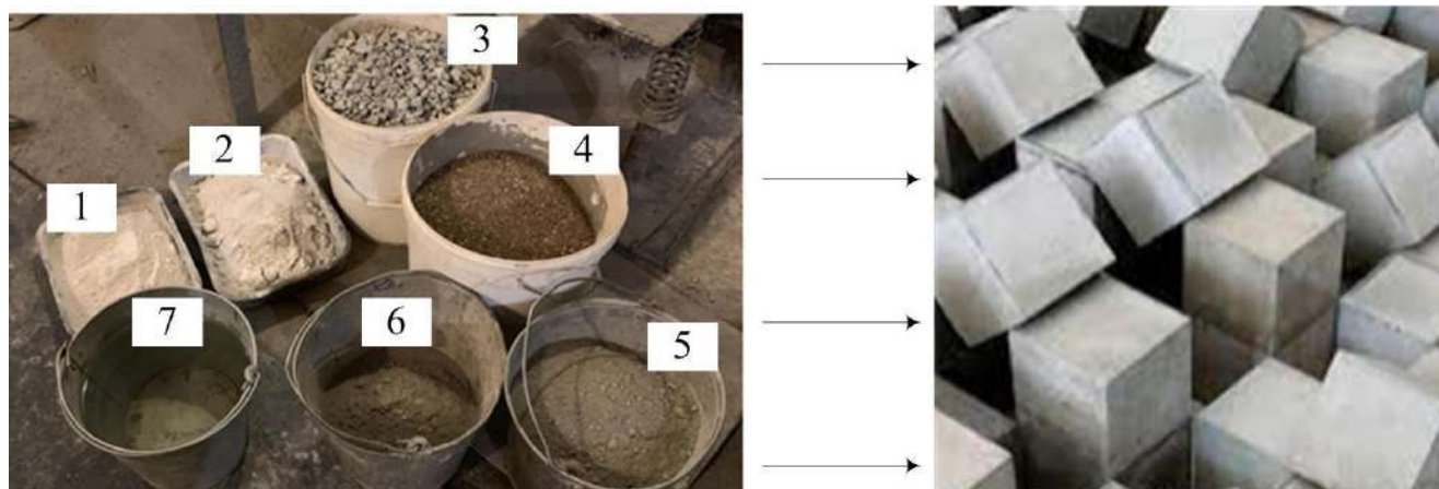
Рисунок 3.4 – Вид материалов и изготовленных образцов: 1, 2 – модификатор бетона «Эмбэлит»; 3 – щебень; 4 – песок мытый; 5, 6 – портландцемент; 7 – вода питьевая с пластификатором
