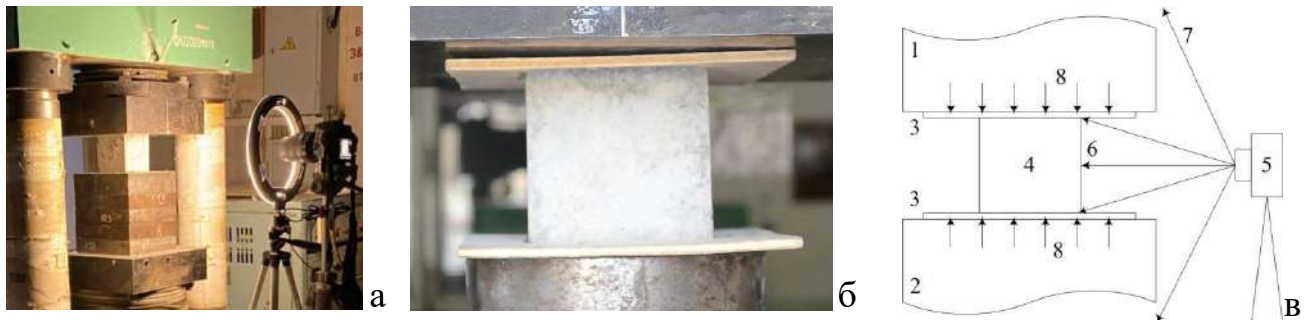
Рисунок 3.9 – Лабораторная установка для проведения исследований: а – общий вид лабораторной установки; б – натуральный образец; в – схема исследования
