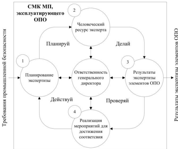
Рисунок 10 – Схема цикла PDCA для процесса экспертизы промышленной безопасности элементов ОПО
