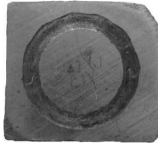
Рисунок 5.17 – Фотография образца после триботехнических испытаний из стали марки 38ХМЮА после ТО [181]
