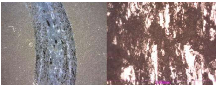
Рисунок 2.17 – Пример оптической фотографии трека износа
