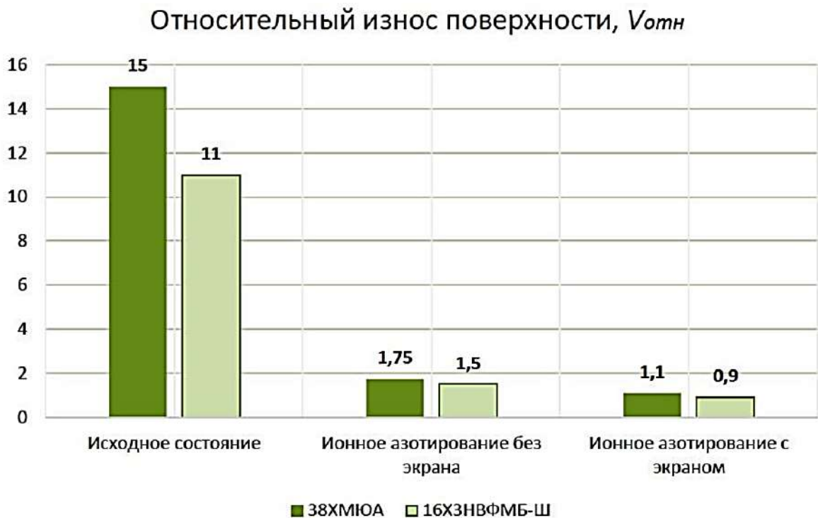
Рисунок 5.25 – Сравнительная износостойкость поверхности образцов в зависимости от метода обработки: а – ТО, б – ИА без ПК, в – ИА с ПК [181]
