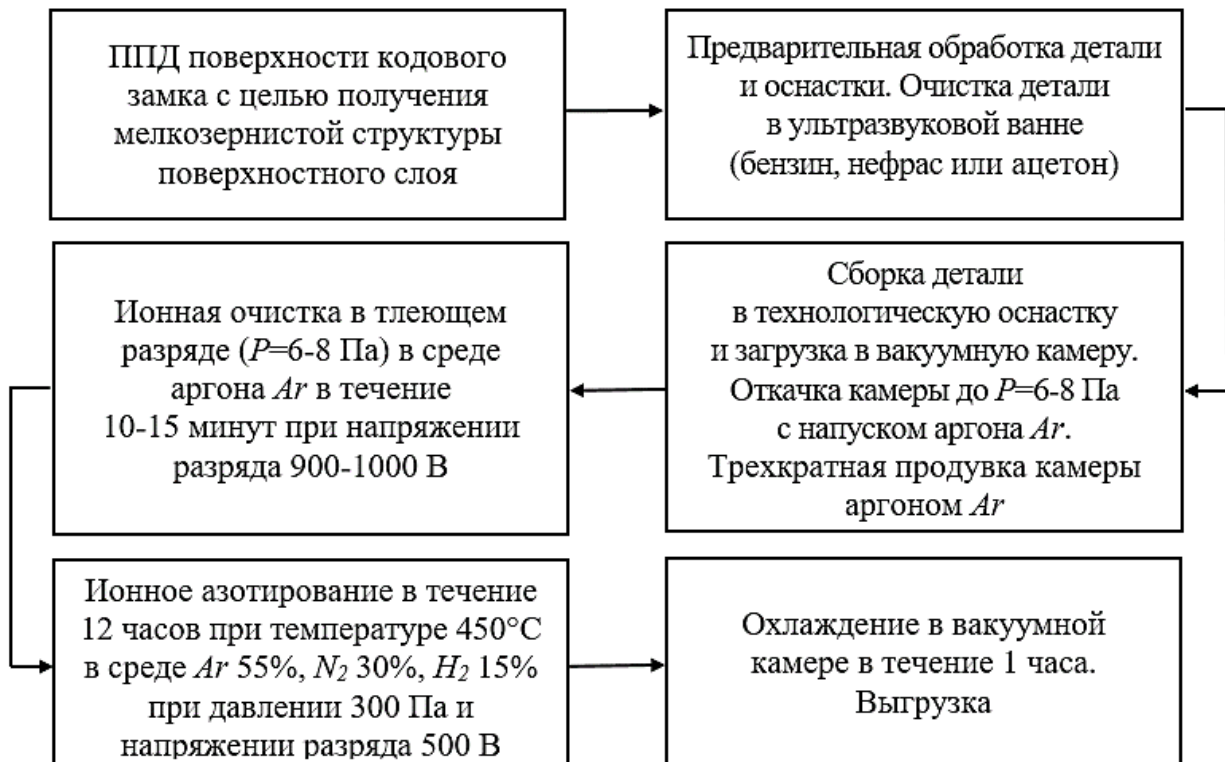
Рисунок 33 – Блок-схема ТП низкотемпературного ЛИА детали «шток»
