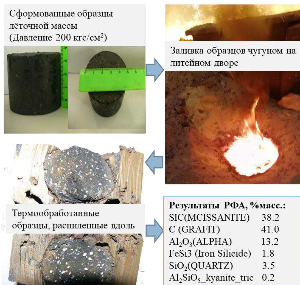
Рисунок 6.10 – Усреднённые результаты рентгенофазового анализа пяти образцов лёточной массы состава №2 после термообработки чугуном на литейном дворе доменной печи №4
