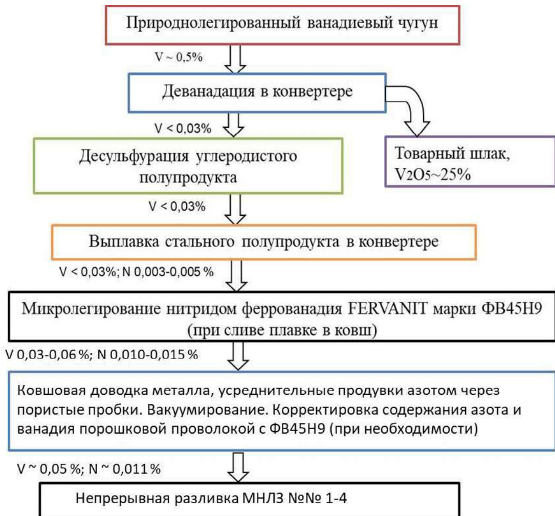
Рисунок 5.4 – Технологическая схема микролегирования азотсодержащих сталей типа 16Г1АФ-1 и К76ХФ в конвертерном цехе «ЕВРАЗ НТМК»
