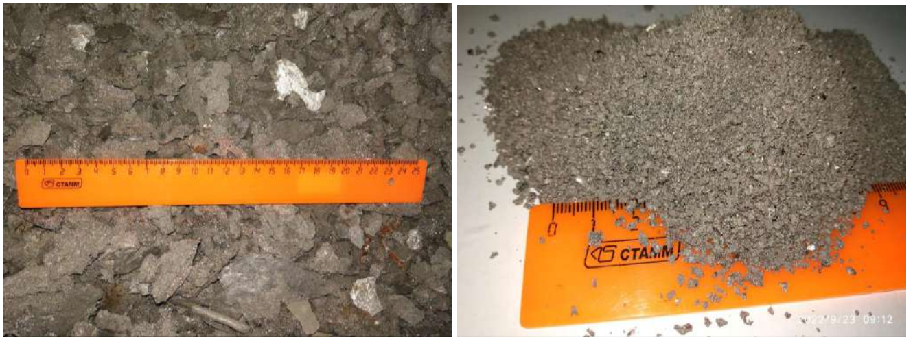
Рисунок 3.38 – Некондиционная титановая губка (счистка с реторт): слева – исходный материал, справа – после измельчения и просеивания на сите 2 мм
