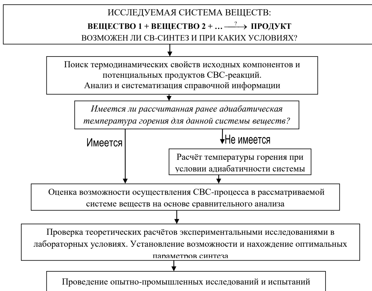
Рисунок 2.1 – Методика оценки возможности использования СВС-метода для получения продуктов в режиме горения
