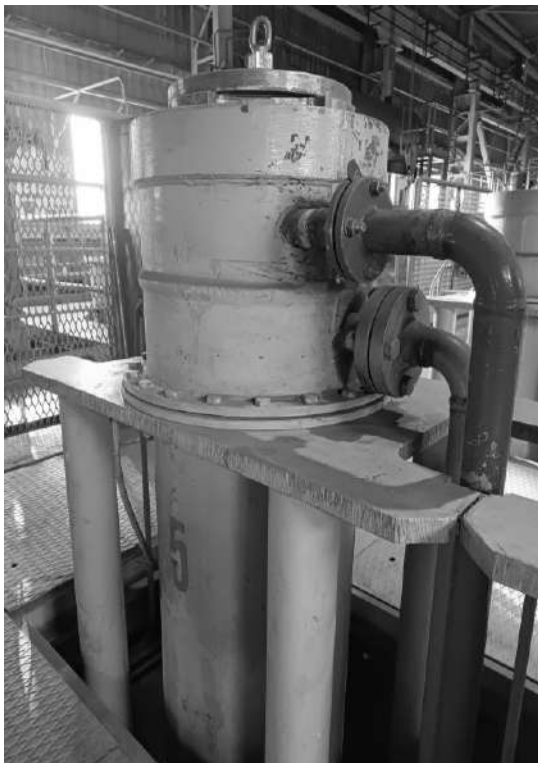
Рисунок 4.9 – Устройство и внешний вид СВС-реактора объёмом 0,15 м 3
