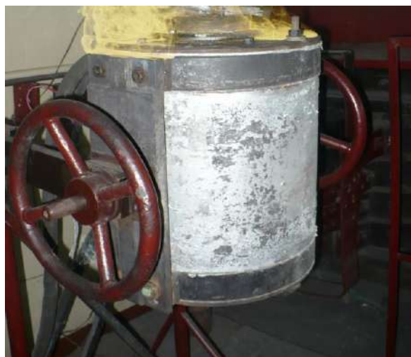
Рисунок 6.8 – Спекание образцов лёточных масс в печи Таммана
