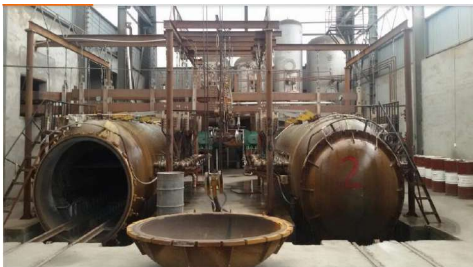
Рисунок 1.3 – Вакуумные печи сопротивления для азотирования брикетов ферросплавов
