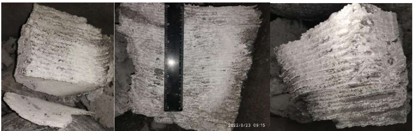
Рисунок 3.33 – Вид продольных сечений образцов нитрида ферросилиция, сгоревших в автоколебательном режиме при азотировании циклонных пылей ферросилиция: ПУД-ФС75 (слева); ПУД-ФС65 (в центре); ПУД-ФС45 (справа) P_{\text{N}_2}=5\text{МПа} ; d = 250\text{мм} ; пористость шихты 65-70% (свободная засыпка).
