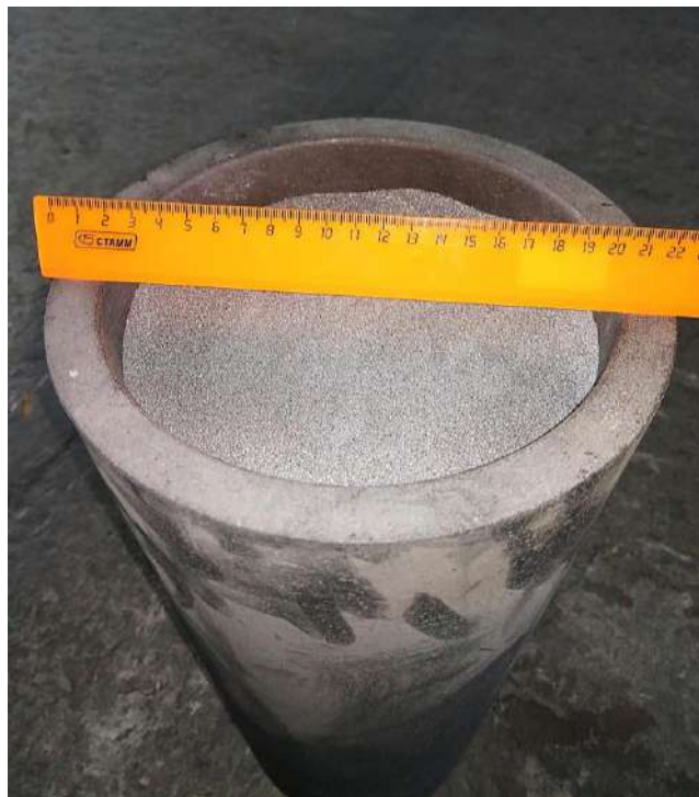
Рисунок 3.11 – Графитовый тигель Ø190 мм с порошком феррохрома для спекания в проточном СВС реакторе
