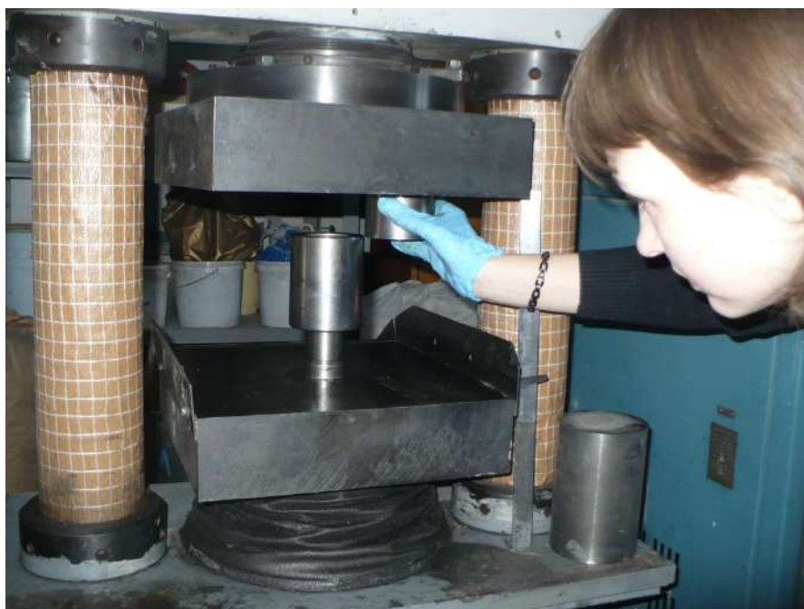
Рисунок 6.7 – Формование образцов лёточных масс Ø50мм на прессе ИП-1000М
