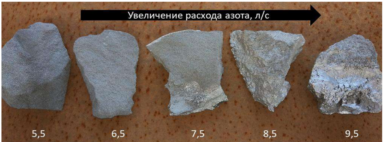
Рисунок 3.16 – Макроструктура нитрида феррохрома в зависимости от расхода азота. Давление азота 4,5МПа.
