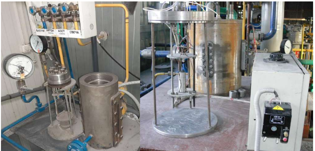
Рисунок 3.3 – Лабораторные СВС-реактора: БПД-3 объёмом 3 дм 3 (слева) и БПД-15 объёмом 15 дм 3 (справа)
