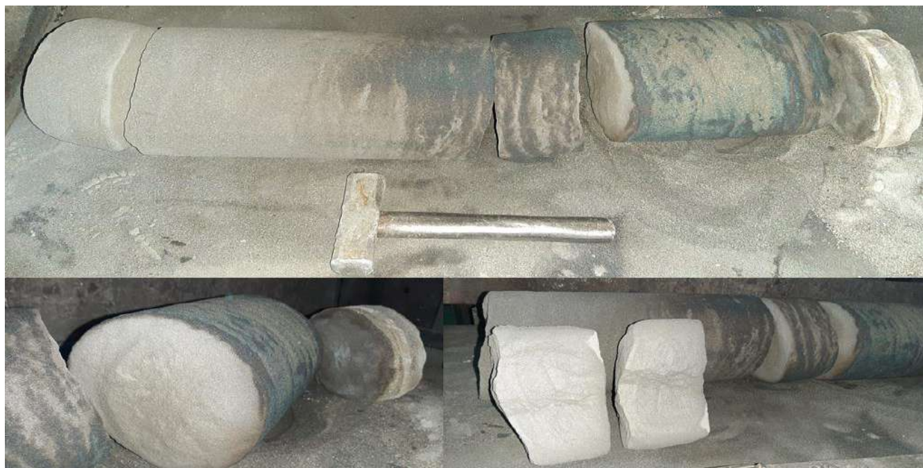
Рис. 3.13 – Внешний вид и макроструктура спёка нитрида феррохрома \text{Ø}190 \times 950 \text{ мм} , массой 90 кг, синтезированного в проточном СВС-реакторе. Давление азота 5 МПа, расход 7,5 л/с
