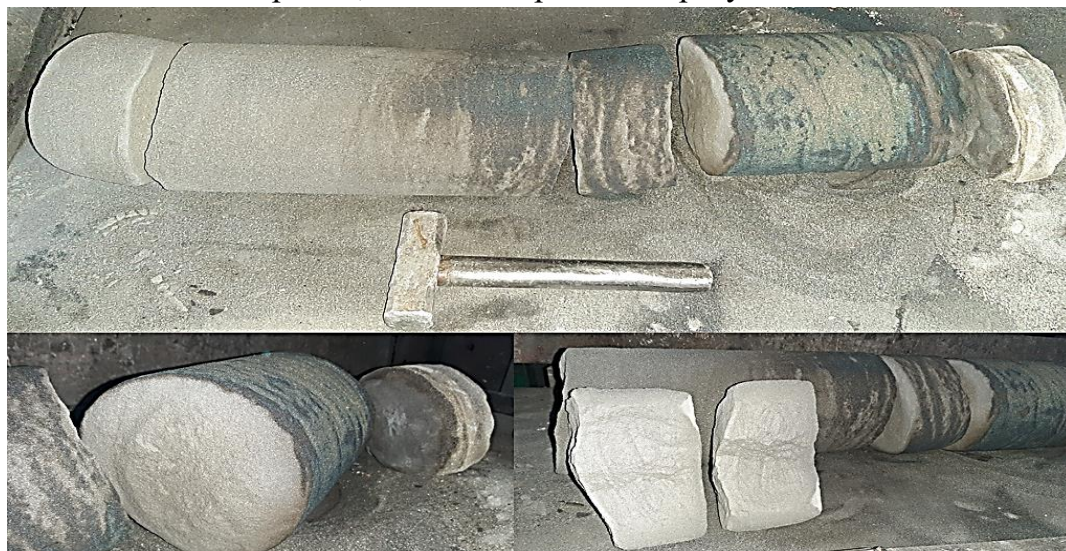
Рисунок 9 – Внешний вид и макроструктура спека нитрида феррохрома ( \text{Ø}190 \times 950 мм, m = 90 кг), впервые синтезированного в проточном СВС-реакторе в режиме спутного горения. Давление азота 5 МПа, расход 7,5 л/с.
