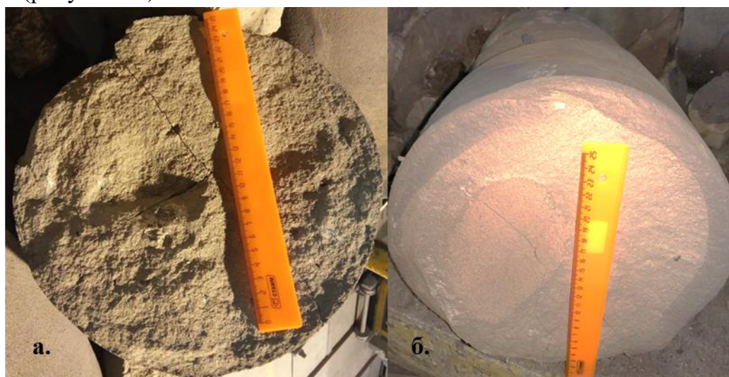
Рисунок 13 – Макроструктура опытно-промышленных образцов нитрида феррованадия ( \text{Ø}280 \text{ мм} , m \sim 200 \text{ кг} ), синтезированных из FeV-отсевов. а – нитрид FeV80 ( \beta\text{-V}_2\text{N} , \delta\text{-VN} , \alpha\text{-Fe} ); б – нитрид ФВд50 ( \delta\text{-VN} , \alpha\text{-Fe} )
