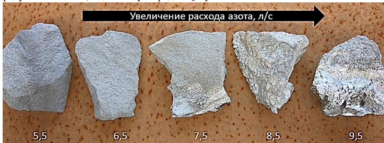
Рисунок 11 – Макроструктура нитрида феррохрома в зависимости от расхода азота. Давление азота 4,5 МПа.
