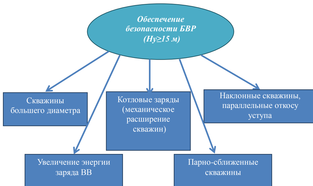
Рисунок 3.4 – Методы управления энергией взрыва для обеспечения безопасности бурения первого ряда скважин при высокоуступной технологии
