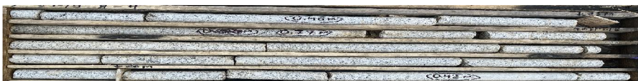
ИГЭ 19.5 Гранит, очень плотный, непористый, средней прочности, малотрещиноватый
