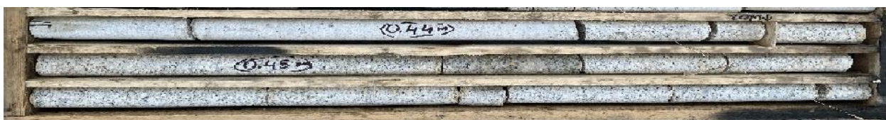
ИГЭ 19.4 Гранит, очень плотный, малопористый, прочный, малотрещиноватый
