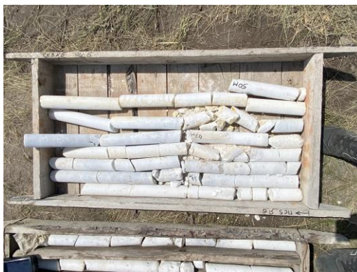
Рисунок 2.7 – Керны Полоцкого месторождения мрамора в период эксплуатационной разведки
