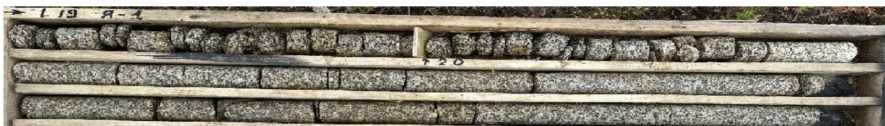
ИГЭ 19.1 Гранит, очень плотный, пористый, средней прочности, сильнотрещиноватый
