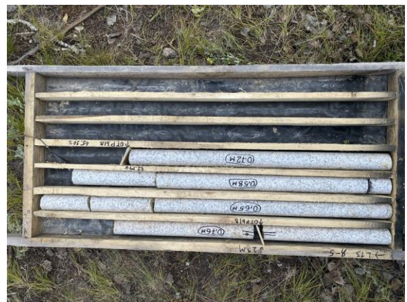
Рисунок 2.8 – Керны Алексеевского месторождения гранитов в период поисковой разведки
