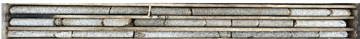
ИГЭ 19.2 Гранит, очень плотный, пористый, средней прочности, среднетрещиноватый
