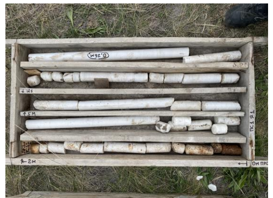
Рисунок 2.7 – Керны Полоцкого месторождения мрамора в период эксплуатационной разведки
