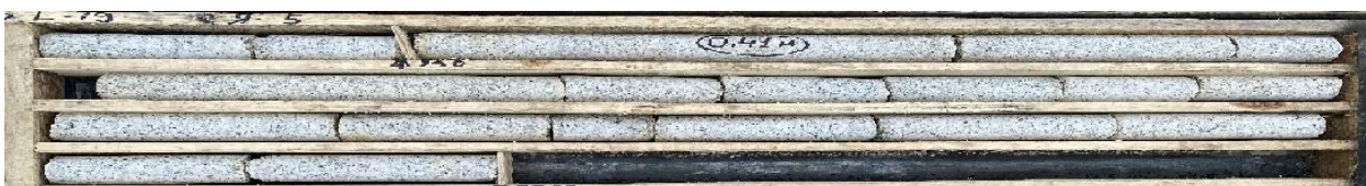
ИГЭ 19.6 Гранит, очень плотный, непористый, очень прочный, малотрещиноватый
