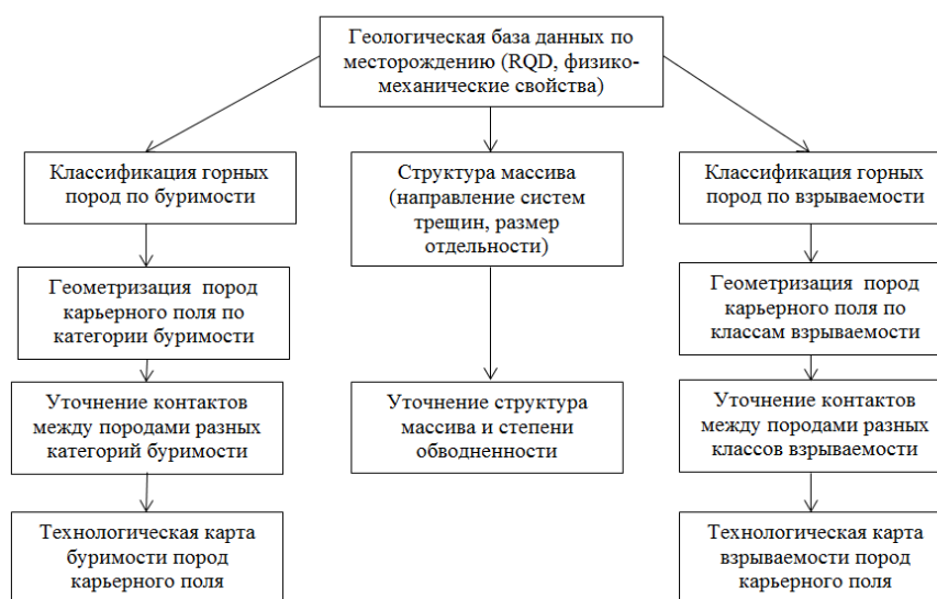
Рисунок 2.23 – Схема составления технологических карт по буримости и взрываемости горных пород на карьерах
