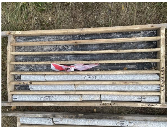
Рисунок 2.8 – Керны Алексеевского месторождения гранитов в период поисковой разведки
