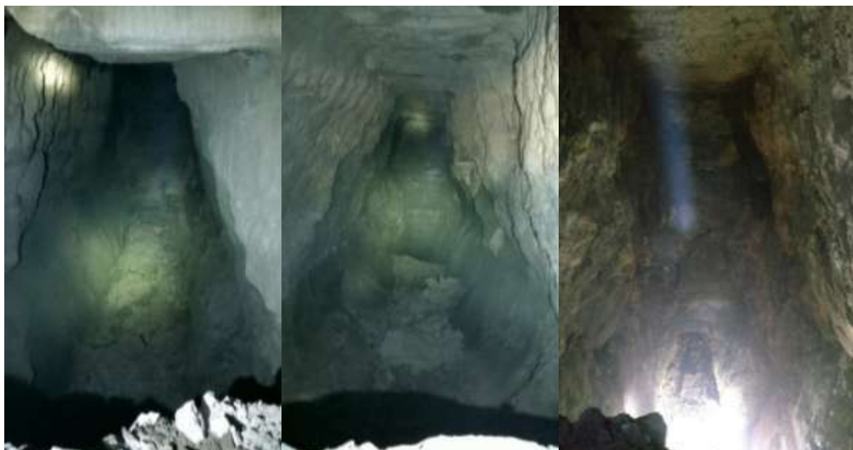
Рисунок 4.9 – Выработанное пространство ромбовидных камер (верхние борта)
