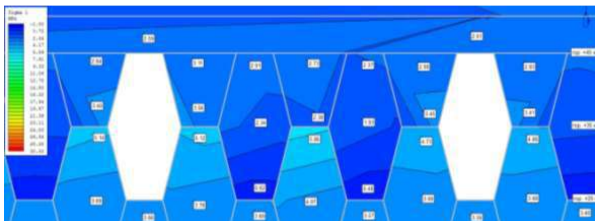
Рисунок 3.12 – Схема распределения напряжений в рудном и искусственном массивах при отработке запасов в подэтаже +45/+25 м: а – выемка через один комбинированный целик; б – выемка через три целика; в – через пять целиков
