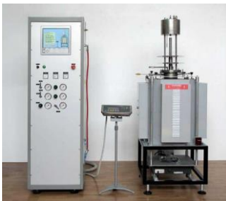
Рисунок 1 – Автоматизированный комплекс LECO для испытаний металлургических свойств железорудных материалов при высокотемпературном восстановлении под статической нагрузкой (а); программа подачи газов при испытаниях агломерата (б)
