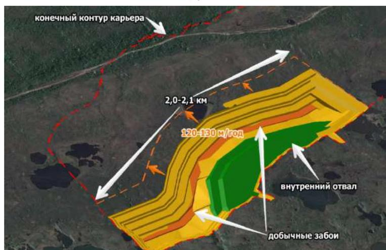
Рисунок 4.13 – Продольная система разработки на Северо-Мокулаевском карьере
