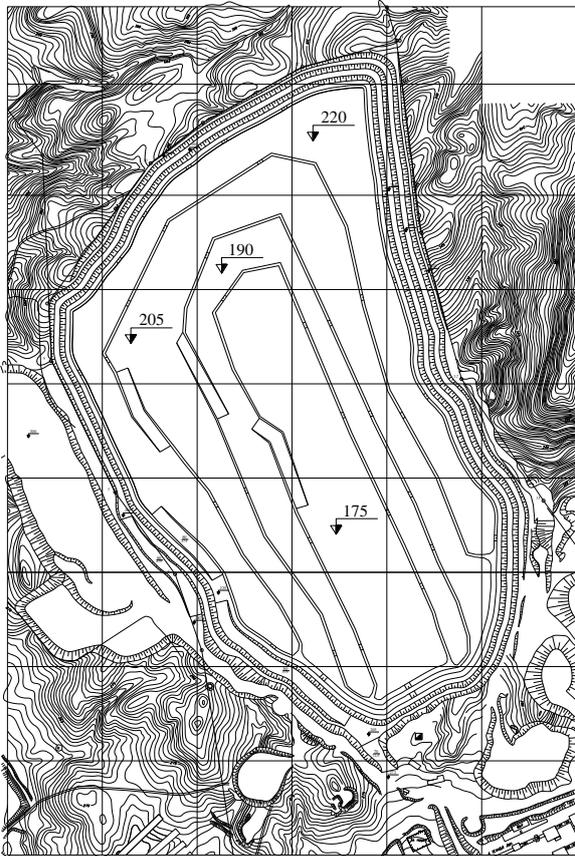
Рисунок 6.11 – Промежуточный план горных работ с кольцевым фронтом работ
