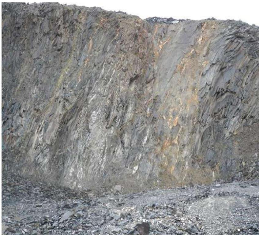
Рисунок 4.40 – Кварцевые включения и жилы на добычном уступе
