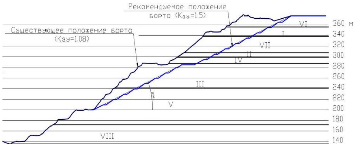
Рисунок 4.20 – Рекомендуемые параметры откоса северного и северо-восточного бортов (разрез по линии 2-2)
