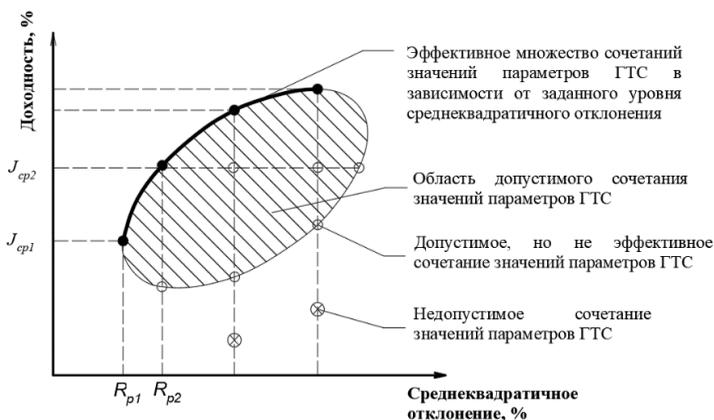
Рисунок 2 - Графическая информационная модель, показывающая область вариантов при различных сочетаниях значений основных показателей и параметров горнотехнической системы
