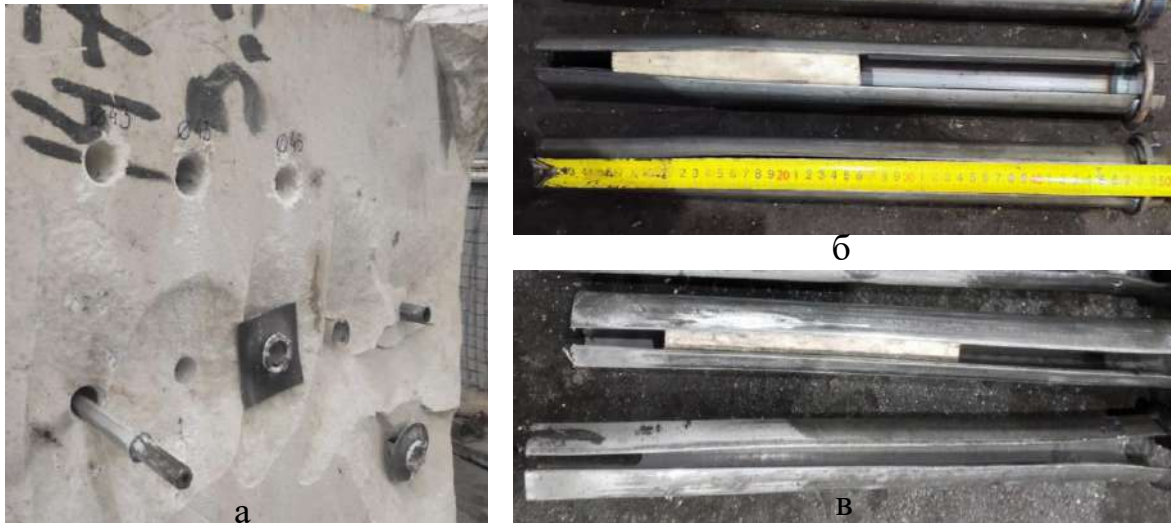
Рисунок 4.28. Фото экспериментального мраморного блока: а – общий вид блока; б – анкера до установки в шпур; в – анкера после изъятия из шпура
