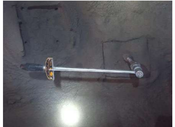
Рисунок 5.8. Вид установленных рамок для определения адгезии
