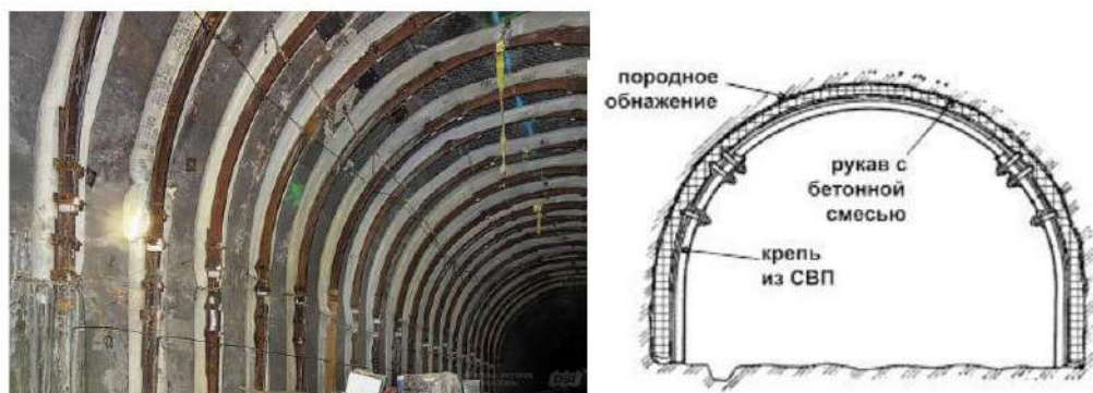
Рисунок 1.3. Конструкция металлической рамной крепи с применением распорного рукава
