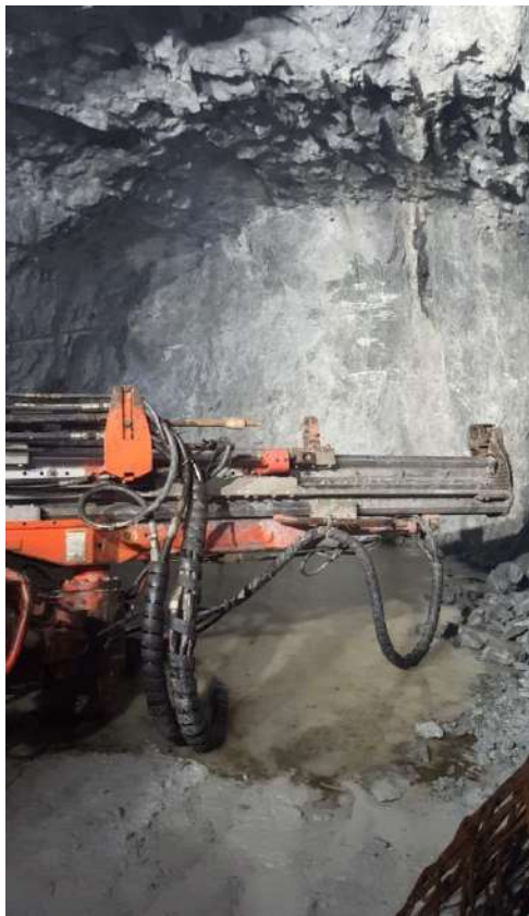
Рисунок 5.2. Стрела буровой кареты с демонтированными вкладышами люнет и установленным пуансоном (слева) и процесс установки СЗА-Армокрепь в сборе (справа)
