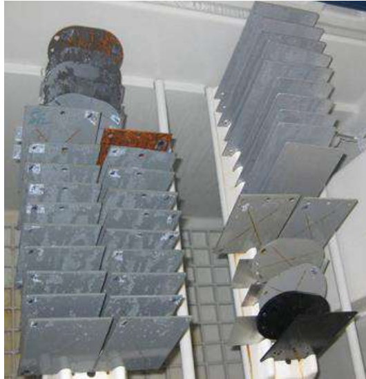
Рисунок 3.39. Покрашенные образцы и образцы с крестообразным надрезом в камере соляного тумана
