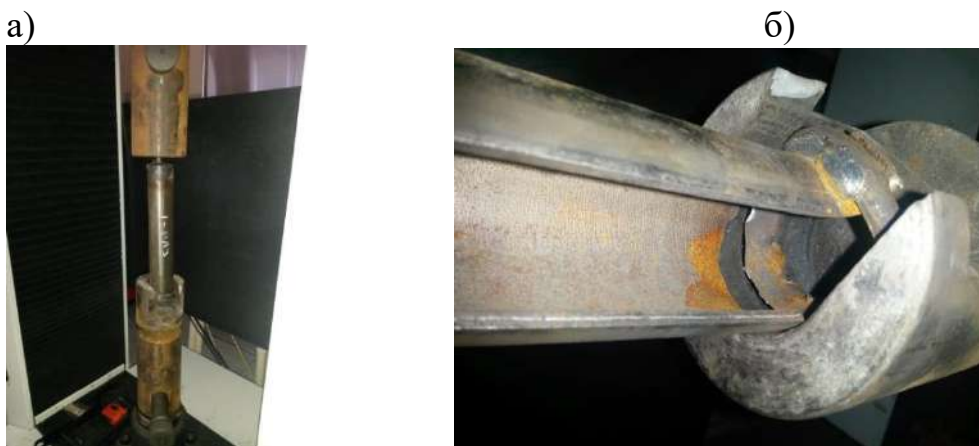
Рисунок 3.29. Вид СЗА в разрывной машине: а - до нагружения; б - после процесса нагружения
