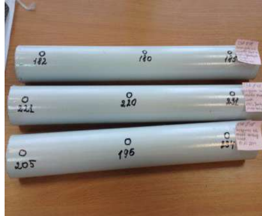
Рисунок 3.38. Определение толщины лакокрасочного покрытия
