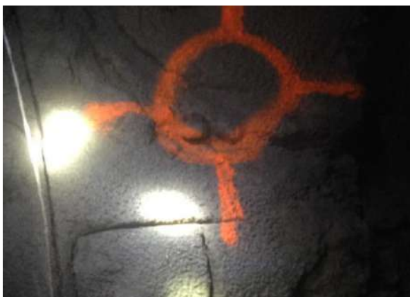
Рисунок 5.21. Разметка мест установки наблюдательных станций (реперов) для определения величины смещения контуров горных выработок
