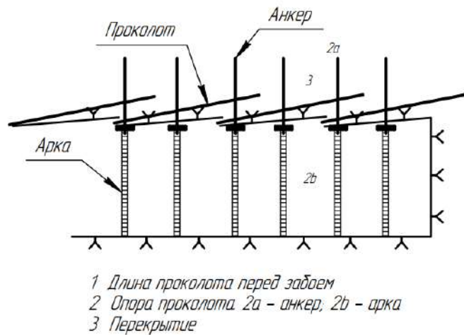
Рисунок 2.26. Схема установки опережающего крепления (продольный разрез выработки)
