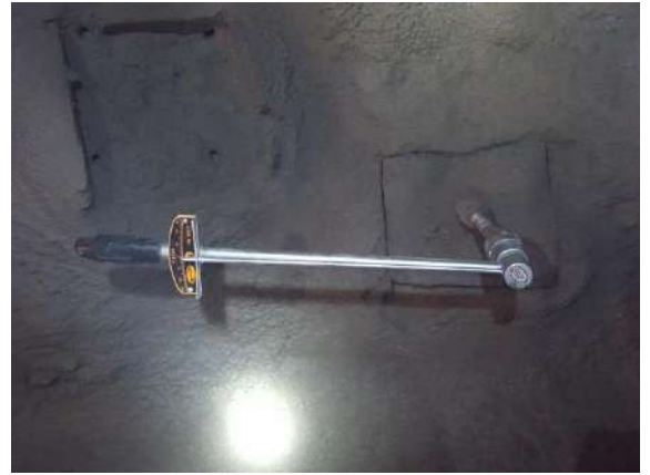
Рисунок 5.8. Вид установленных рамок для определения адгезии
