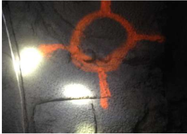
Рисунок 5.21. Разметка мест установки наблюдательных станций (реперов) для определения величины смещения контуров горных выработок
