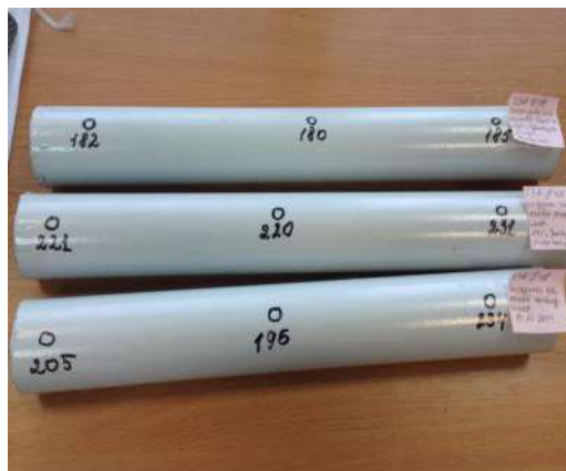
Рисунок 3.38. Определение толщины лакокрасочного покрытия
