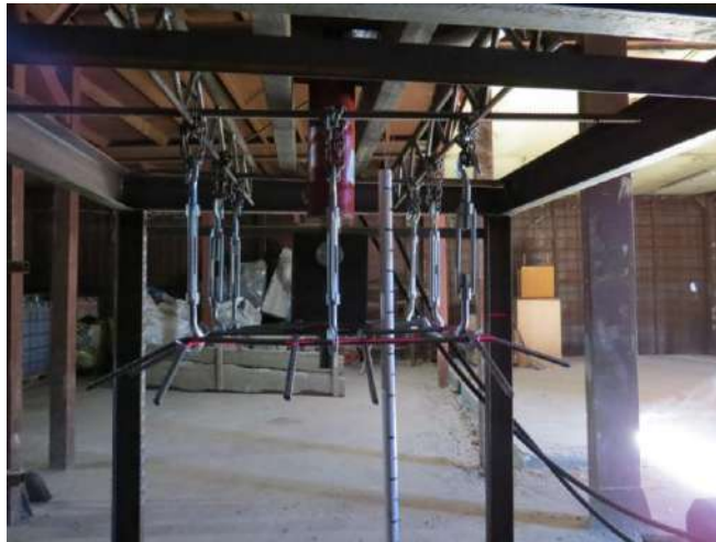
Рисунок 3.34. Подготовка к испытаниям: а – образец; б – установка образца на испытательном стенде; в – выставление лазерного уровня (красная линия)
