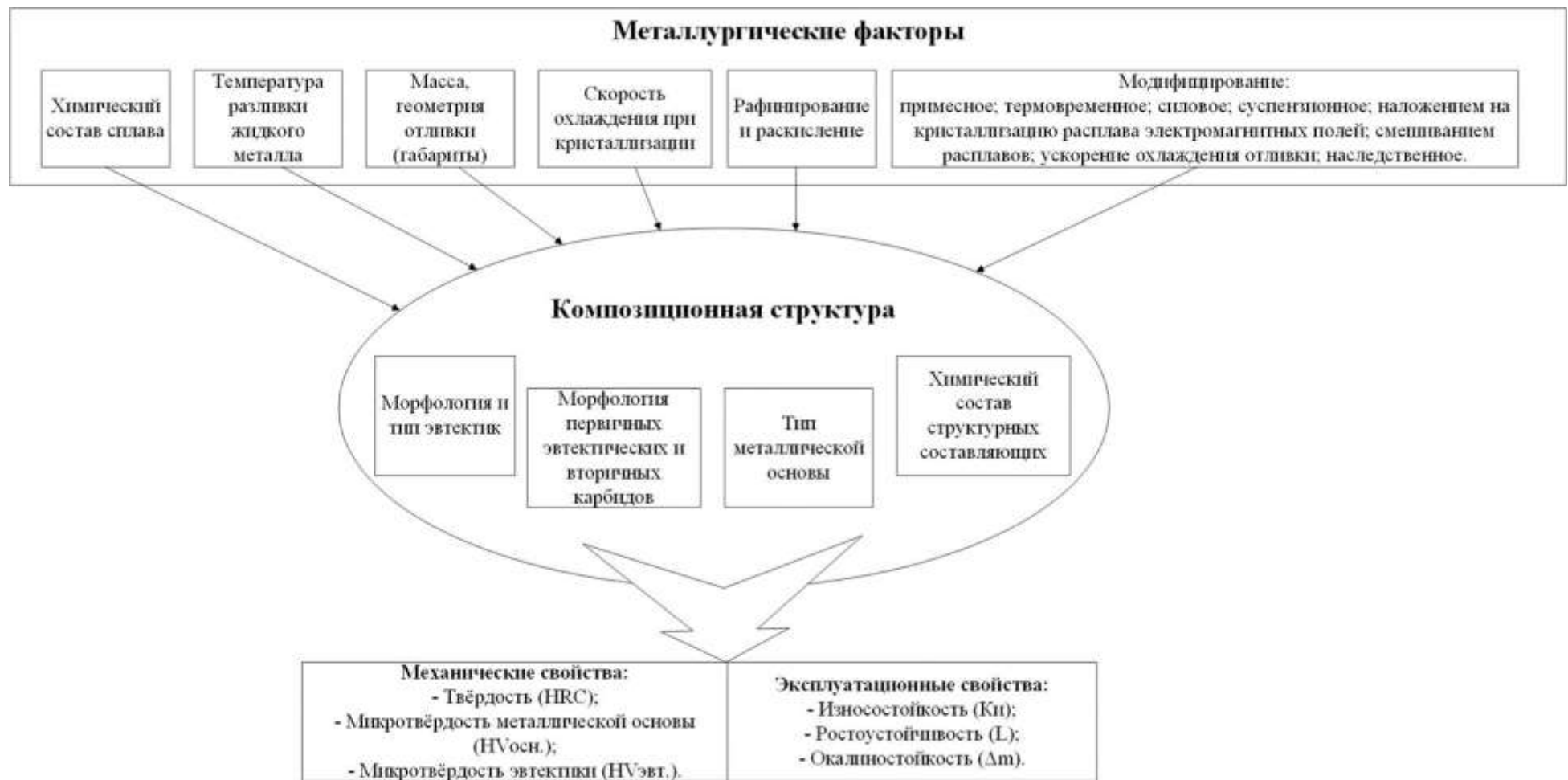
Рисунок 1.4 – Схема влияния металлургических факторов на композиционную структуру опытных сплавов
