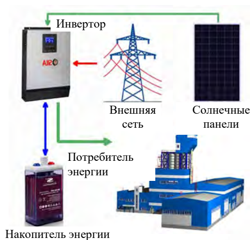
Рисунок 1.6 – Принципиальная схема солнечной фотоэлектрической станции
