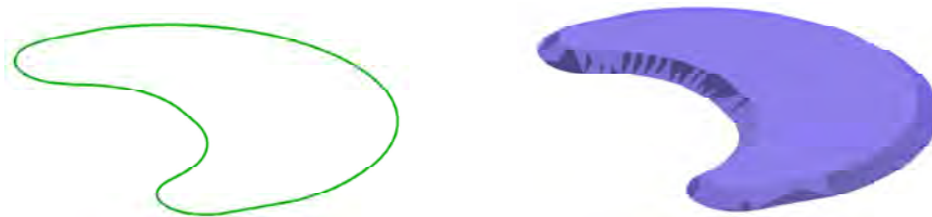
Рисунок П2.4 – Каркасная модель отвала с углом откосов 35°
