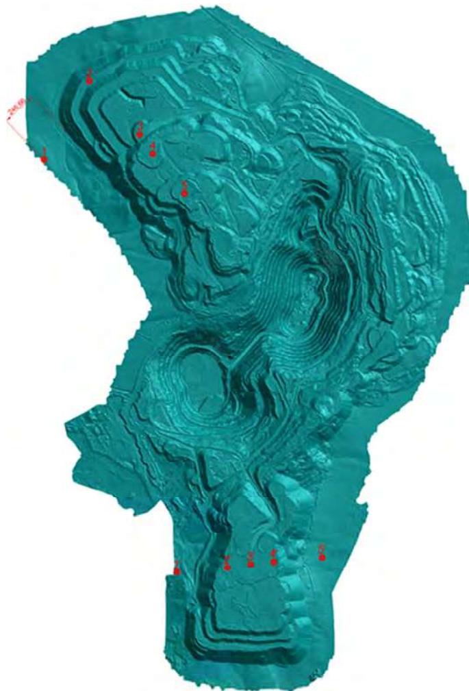
Рисунок ПЗ.1 – Места мониторинга скорости и направления ветра на карьере «Малый Куйбас»
