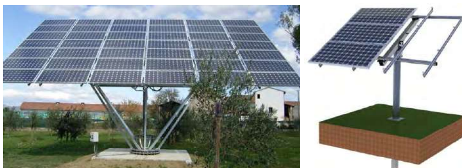
Рисунок 3.6 – Варианты установки солнечных панелей на опорно-поворотных мачтах
