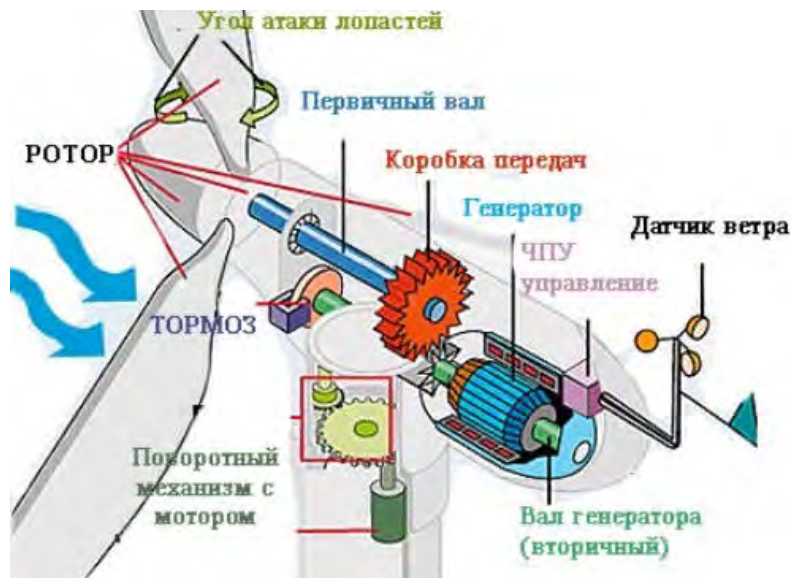
Рисунок 1.9 – Принципиальная схема работы ветрогенератора роторного типа
