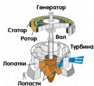
Рисунок 1.10 – Схема работы гидроэлектростанции:
