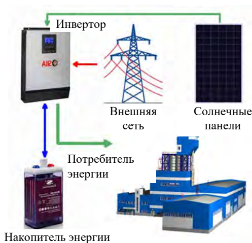
Рисунок 1.6 – Принципиальная схема солнечной фотоэлектрической станции
