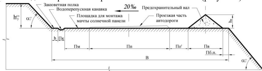
Рисунок 8 – Конструкция горизонтальной транспортной бермы для монтажа:
