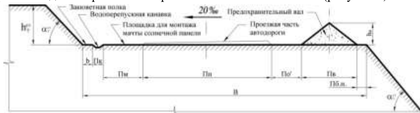
Рисунок 8 – Конструкция горизонтальной транспортной бермы для монтажа:
