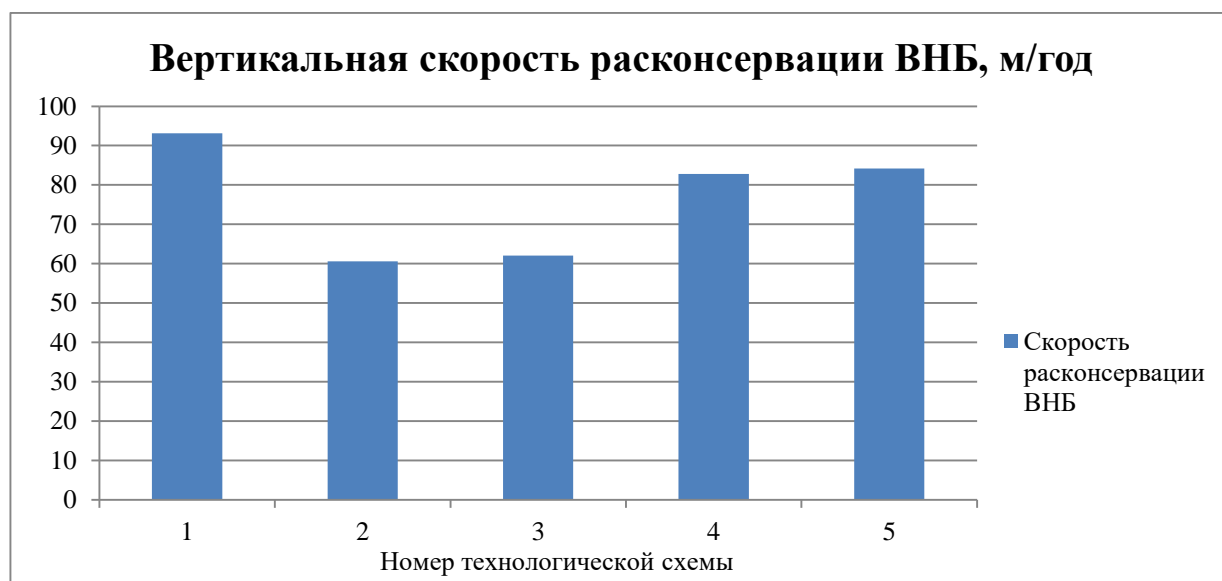
Рисунок 3.12 – Диаграмма вертикальных скоростей расконсервации временно нерабочего борта при использовании различных технологических схем
