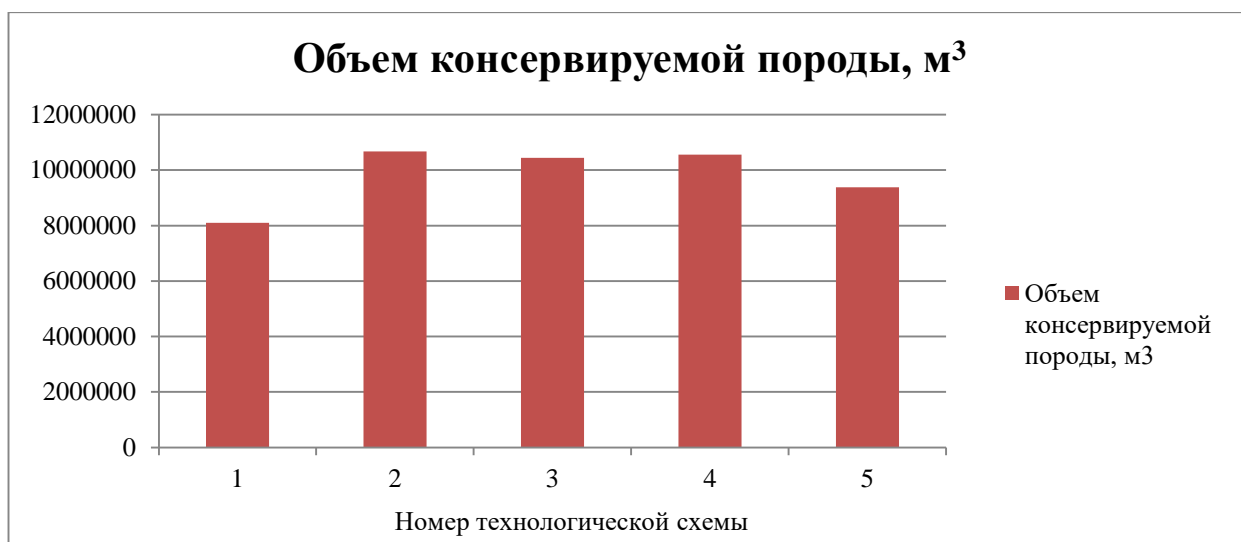
Рисунок 3.11 – Диаграмма консервируемых объемов породы во временно нерабочем борте при использовании различных технологических схем
