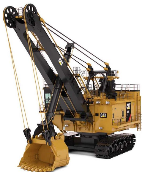
Рисунок 2.4 – Карьерный экскаватор CAT 7495 HD на гусеничном ходу, оборудованный прямой механической лопатой
