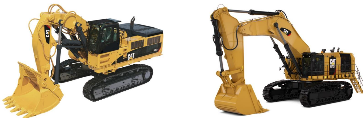
Рисунок 2.5 – Гидравлические экскаваторы CAT 385C FS и CAT 6015B на гусеничном ходу, оборудованные прямой и обратной лопатой
