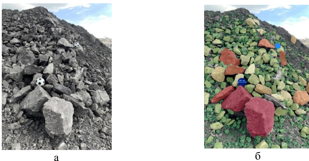
Рисунок 3.4 – Гранулометрический состав в развале Краснобродского угольного разреза: а – вид породы в забое; б – распределение по цветам в зависимости от фракции (CVision.PitFace)
