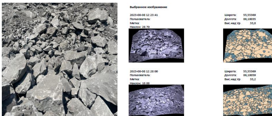
Рисунок 5– Снимки грансостава нижнего горизонта (экскаватор Р&Н – 2800 №152) Кедровского угольного разреза при использовании программного обеспечения: а - CVision.PitFace ; б – PortaMetrics
