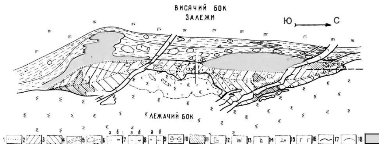
Рисунок 3.2 – Схема размещения текстурных и минеральных типов руд в контурах Учалинского месторождения: 1-5 – текстурные типы руд: 1-колломорфные, 2-мелкозернистые, 3-среднезернистые, 4-слоистые, 5-брекчиевидные; 6-прожилки халькопиритовые редкие (а) и частые (б); 7-вкрапленность халькопирита редкая (а) и частая (б); 8-гнезда сфалерита редкие (а) и частые (б); 9-рудокласты; 10-текстуры брекчиевые и брекчиевидные в сфалеритовом цементе; 11-прожилки кварц-баритовые с полисульфидной минерализацией; 12-хлорит-серицит-кварцевые метасоматиты; 13-туфы и лавы базальтов; 14-вулканомиктовые породы; 15-габбро-диориты; 16-контур рудного тела; 17-границы литологические; 18-текстуры зернистые и колломорфные
