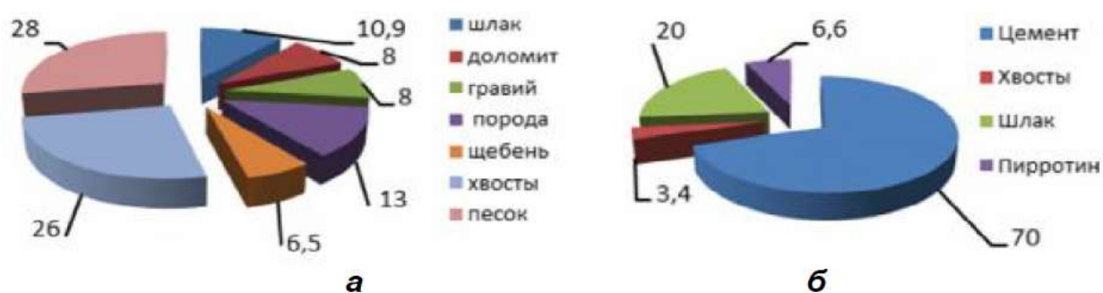
Рисунок 1.12 – Диаграмма использования инертных (а) и вяжущих материалов (б) в закладочных работах (%)
