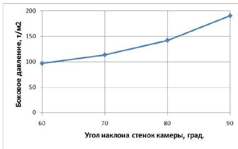
Рисунок 3.12 – Зависимость бокового давления сыпучей закладки от угла наклона камеры
