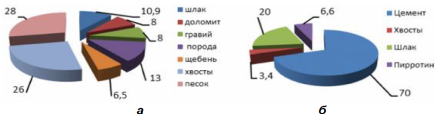
Рисунок 1 – Доли использования материалов в составе твердеющей закладки (%): а – инертные и б – вяжущие материалы
