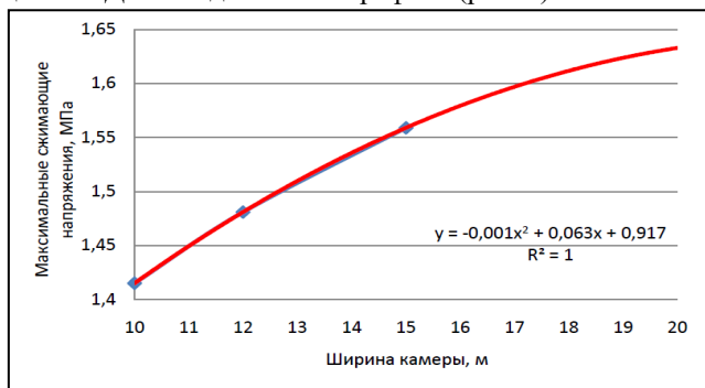
Рисунок 8 – Зависимость максимальных сжимающих напряжений при различных значениях ширины камеры
