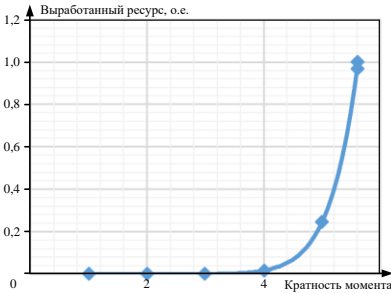
Рис. 12. Зависимость выработки ресурса от кратности момента при захвате
