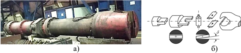
Рис. 2. Фотография шпинделя (а) и конструкция шпиндельного соединения (б)
