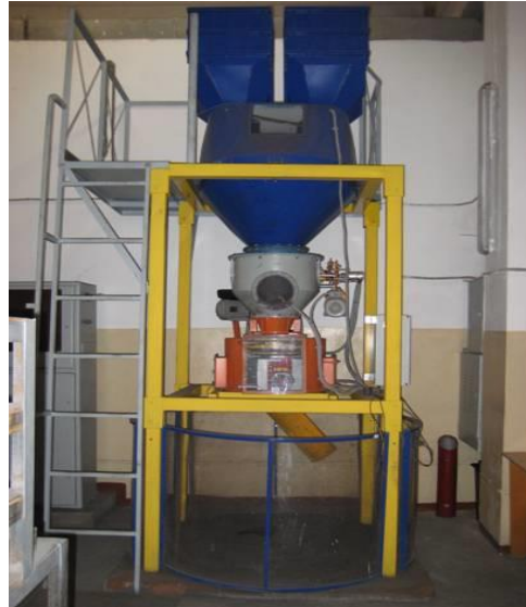
Рисунок 2.4 – Физическая модель однотокового компактного загрузочного устройства лоткового типа
