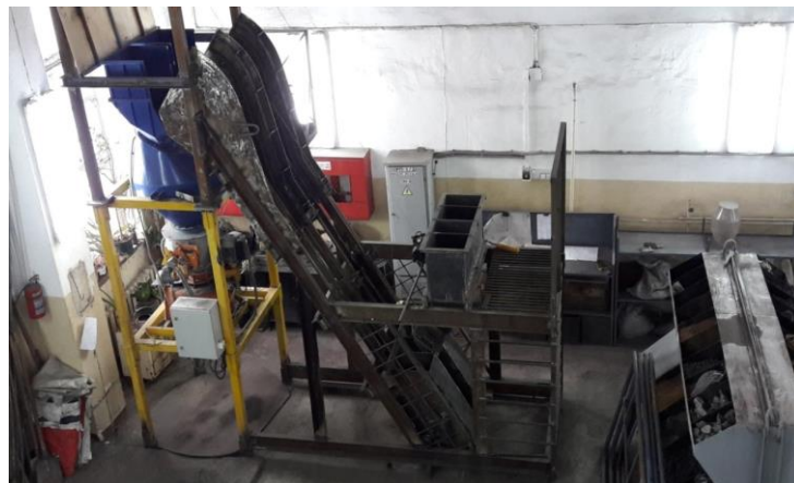
Рисунок 2.5 – Скиповая система загрузки шихтовых материалов в физическую модель бесконусного загрузочного устройства
