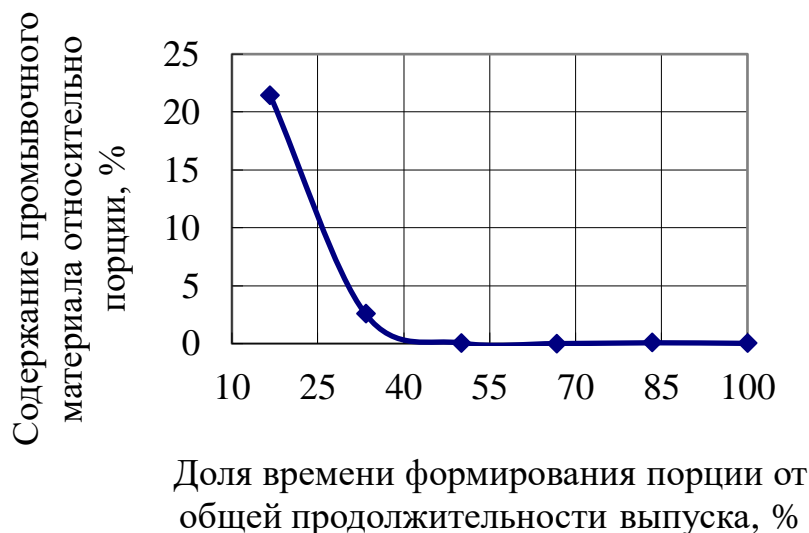
Рисунок 3.1 – Содержание промывочного материала по мере истечения его совместно с железорудным сырьем из шихтового бункера БЗУ при расположении его в нижней части бункера БЗУ
