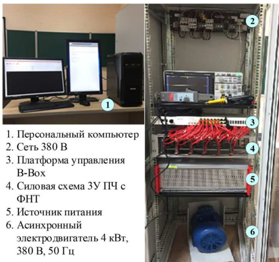
Рисунок 4.1 – Общий вид лабораторного комплекса «Трехуровневый силовой преобразователь»
