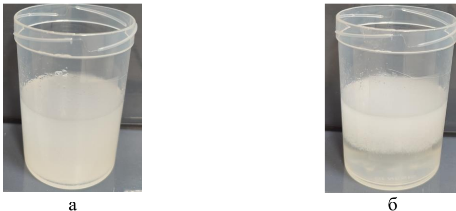
Рисунок 3.20 – Смесь гидролизованного раствора этилсиликата и пеногасителя:
