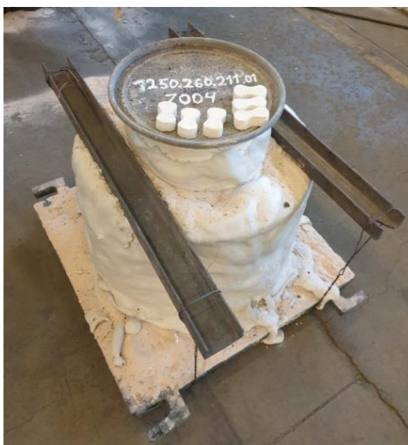
Рисунок 4.20 – Форма в сборе перед заливкой
