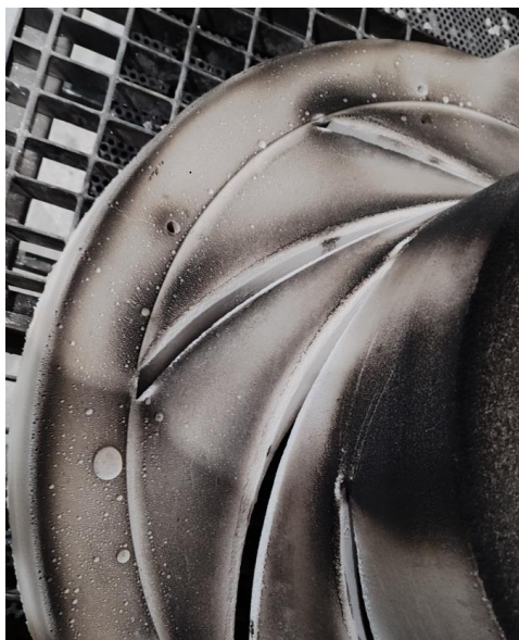
Рисунок 1.11 – Крупные поры диаметром до 10 мм
