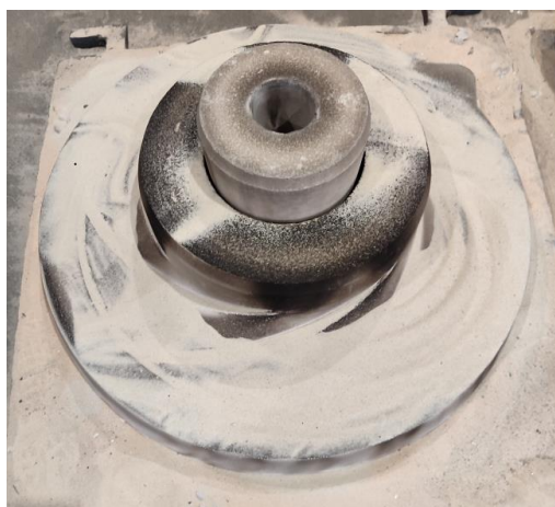
Рисунок 4.18 – Засыпка стержня огнеупорным наполнителем
