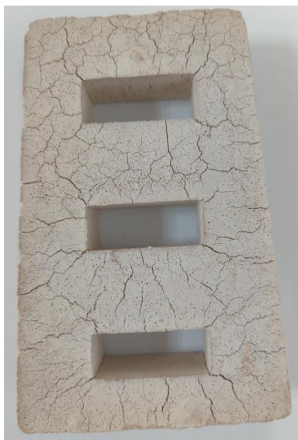
Рисунок 2.22 – Образец 4 балла склонности к образованию трещин
