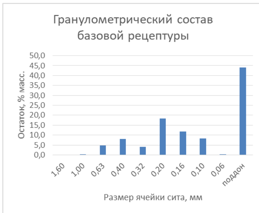
Рисунок 3.6 – Общий гранулометрический состав базовой рецептуры
