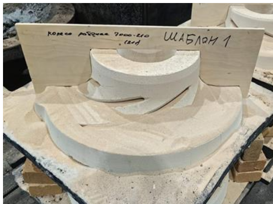
Рисунок 4.17 – Контроль геометрии профиля стержня при помощи шаблона
