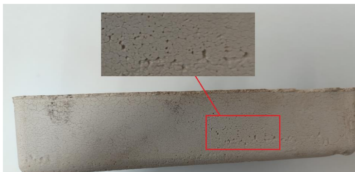
Рисунок 2.25 – Образец 2 балла качество поверхности
