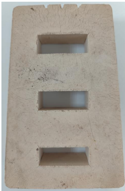
Рисунок 2.19 – Образец 1 балла склонности к образованию трещин
