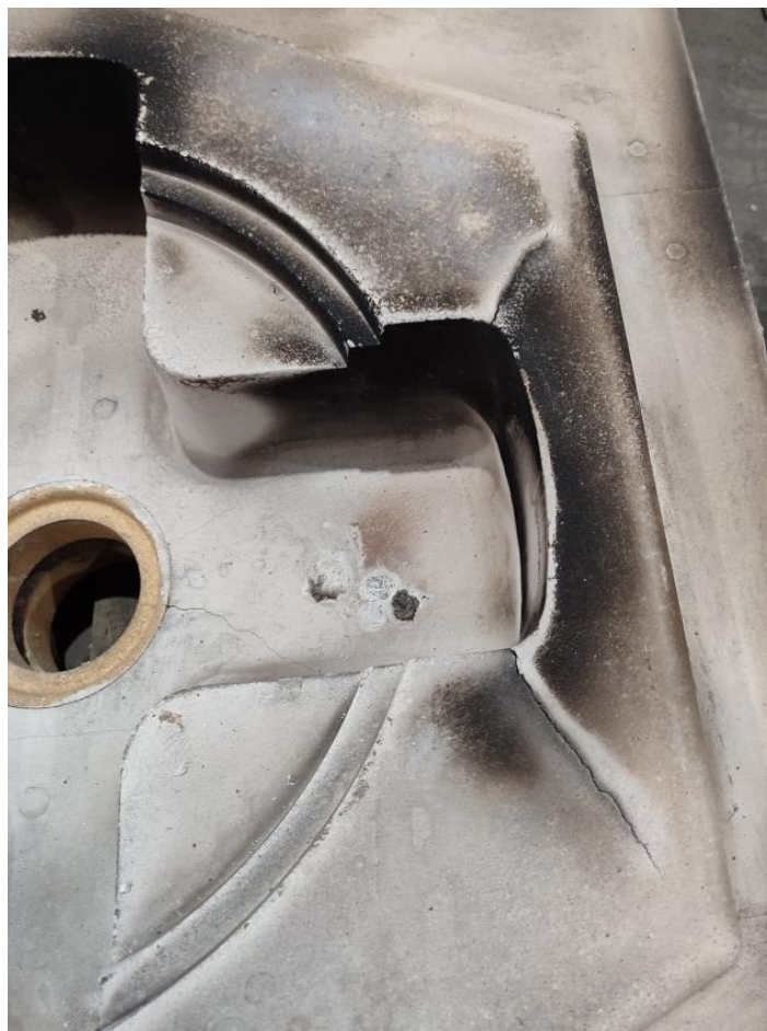
Рисунок 1.10 – Крупные трещины в полуформе верха
