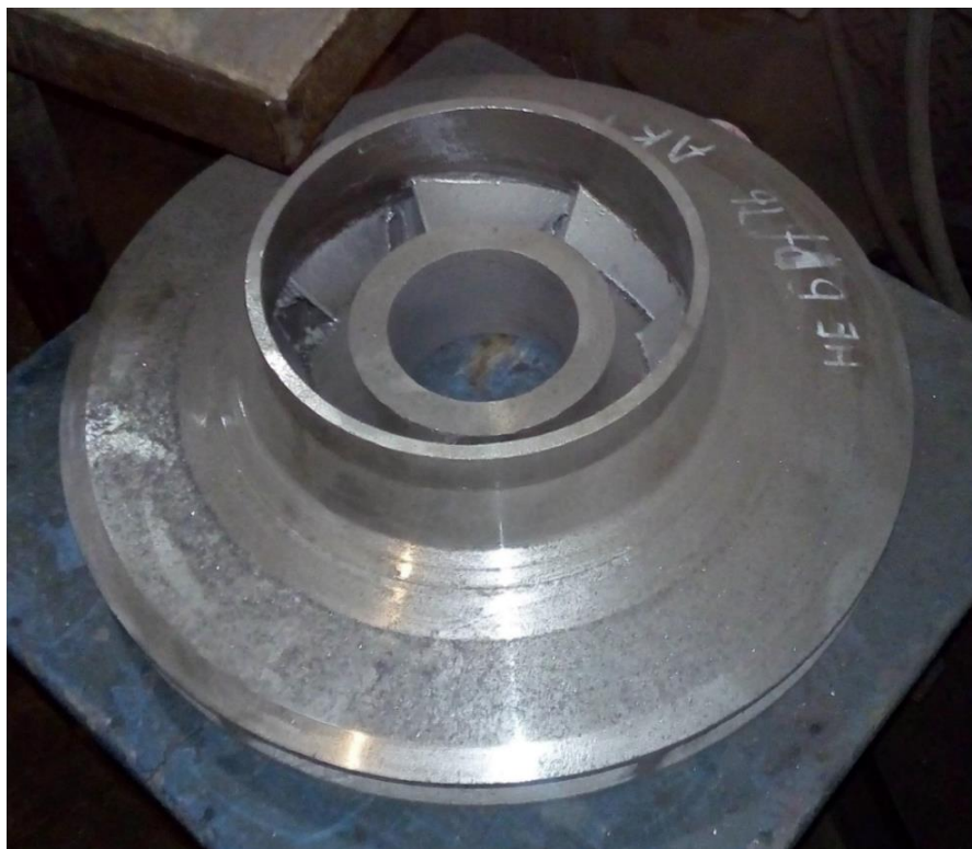
Рисунок 4.27 – Колесо однозаходное (отливка с предварительной механической обработкой)
