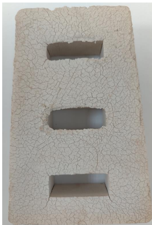
Рисунок 2.21 – Образец 3 балла склонности к образованию трещин
