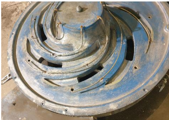
Рисунок 4.13 – Установка каркаса в стержневой ящик
