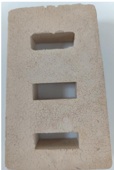
Рисунок 2.20 – Образец 2 балла склонности к образованию трещин
