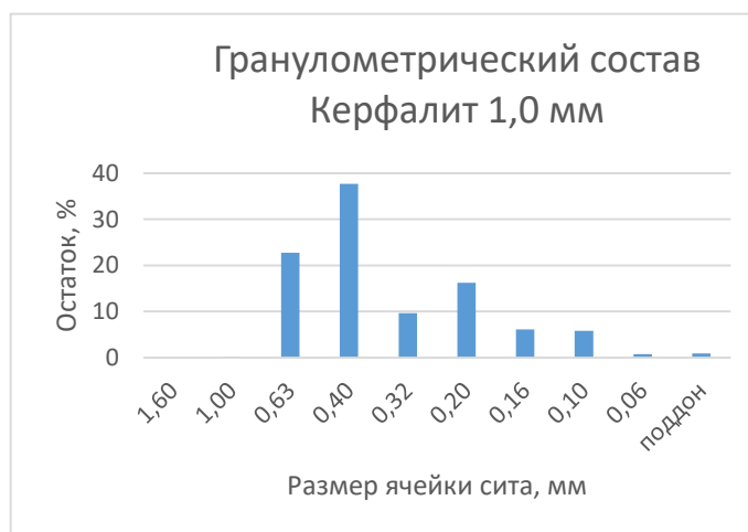
Рисунок 2.7 – Распределение по размеру зерна пробы Kerfalite (0 – 1,0 мм)
