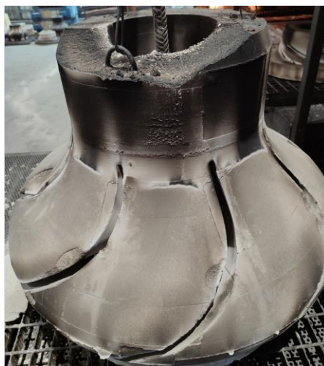
Рисунок 1.13 – Выломы на стержне отливки «Диффузор» при извлечении из МСО
