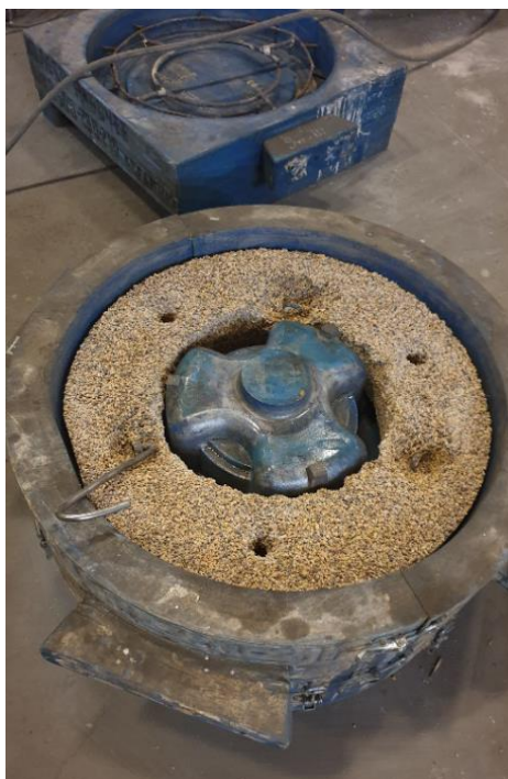
Рисунок 4.11 – Шамотный блок в ящике для заливки керамической суспензией
