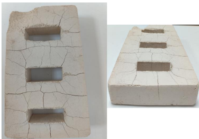
Рисунок 2.23 – Образец 5 баллов склонности к образованию трещин
