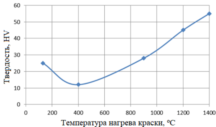
Рисунок 3.4 – Изменение твердости по мере увеличения температуры прокалики для цирконового покрытия
