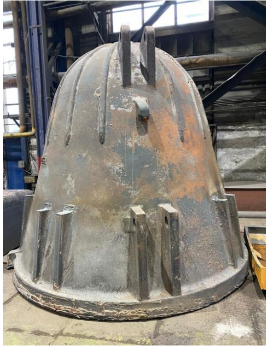
Рисунок 5.4 – Отливка «шлаковая чаша»
